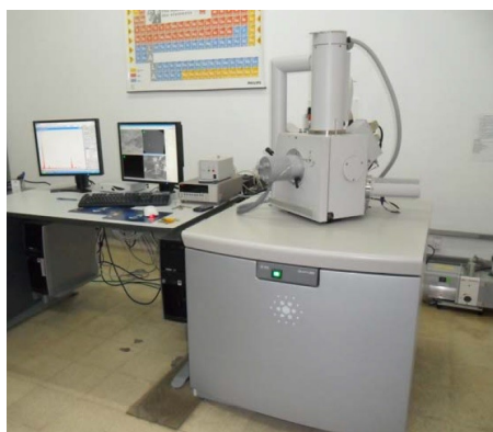
Figura 2.31: Microscopio electrónico de barrido ambiental, FEI Quanta 200, instalado en el LIMF.
