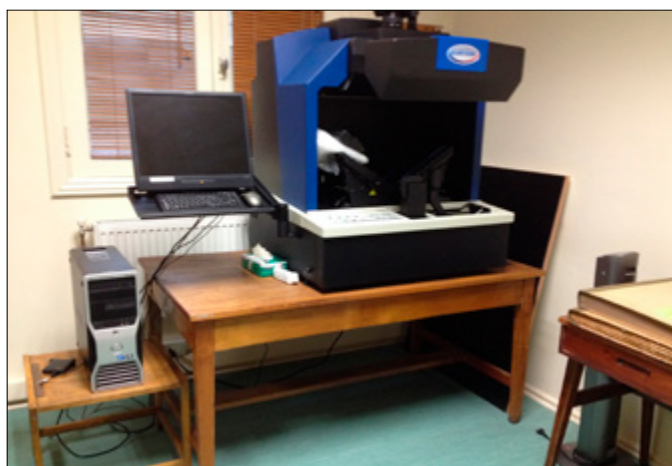
Foto 3: Escáner de libros Kabis II. Parte de los equipos del nuevo laboratorio de digitalización adquiridos en 2013
