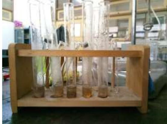
**Gambar 20.** Nanopartikel perak yang telah selesai dibuat.
