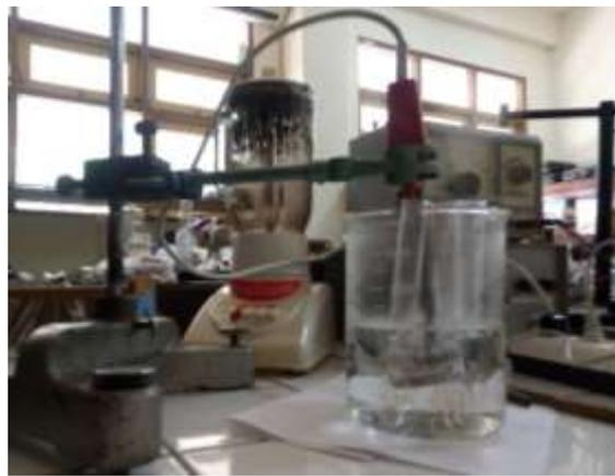
**Gambar 19.** Pemanasan larutan AgNO<sub>3</sub> menggunakan *heater*.
