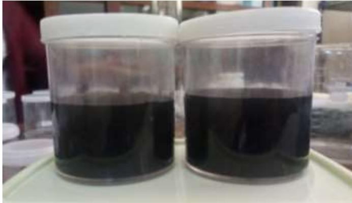
**Gambar 21.** Larutan grafit hasil pencampuran menggunakan blender.
