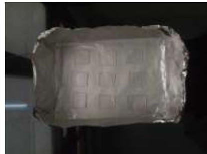
Pembuatan sampel lapisan untuk uji SEM-EDX dan XRD
