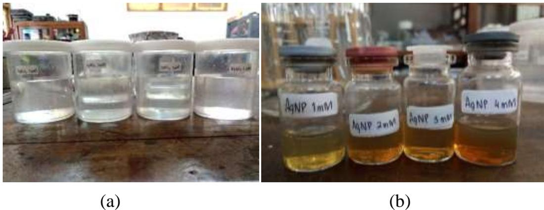
**Gambar 24.** Larutan dengan variasi konsentrasi: a) larutan  $\text{AgNO}_3$  dan b) larutan AgNP.
