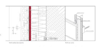
Los perfiles de junta de aluminio ubicados en las juntas verticales están que los paneles vienen con el perfil, la permeabilización de la junta y en particular el tratamiento especial de los perfiles, garantizando así una máxima vida útil.
