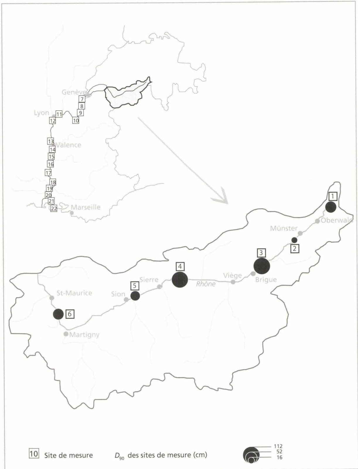
FIGURE 1 – Situation des sites d'étude (numérotés de 1 à 6) et valeurs du  $D_{90}$  des alluvions mesurées sur le Rhône suisse. Sont également indiqués les sites de prélèvement sur le Rhône français.
