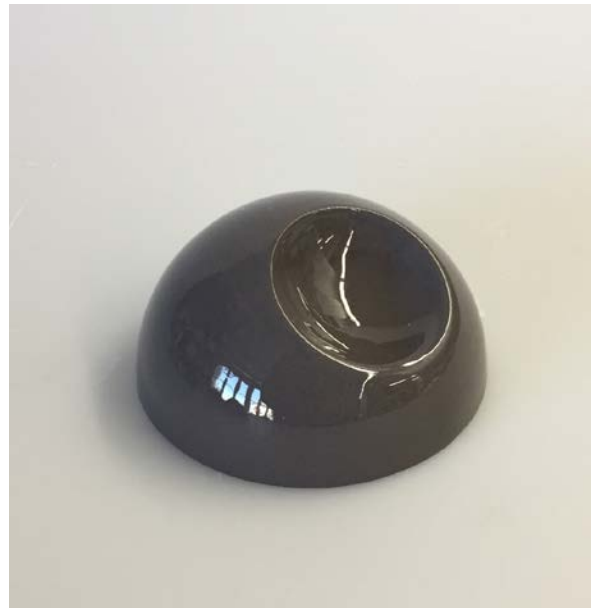
Kuva 9. Värjätyllä valusavella valettu, kirkas mattalasiite HM1 ja kuva 10. Värjätyllä valusavella valettu, kirkas kiiltävä lasite KXX5
