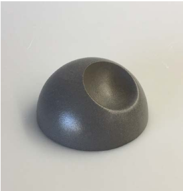
Kuva 9. Värjätyllä valusavella valettu, kirkas mattalasiite HM1 ja kuva 10. Värjätyllä valusavella valettu, kirkas kiiltävä lasite KXX5
