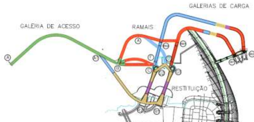
Figura 3-14 – Representação do Circuito Hidráulico. (6)
