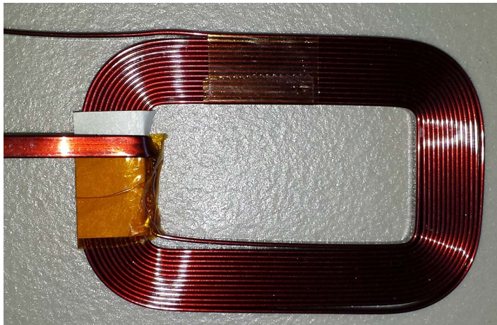
Slika 3.10: Ena tuljava primarnega navitja s štirinajstimi ovoji žice 1 x 5 mm
