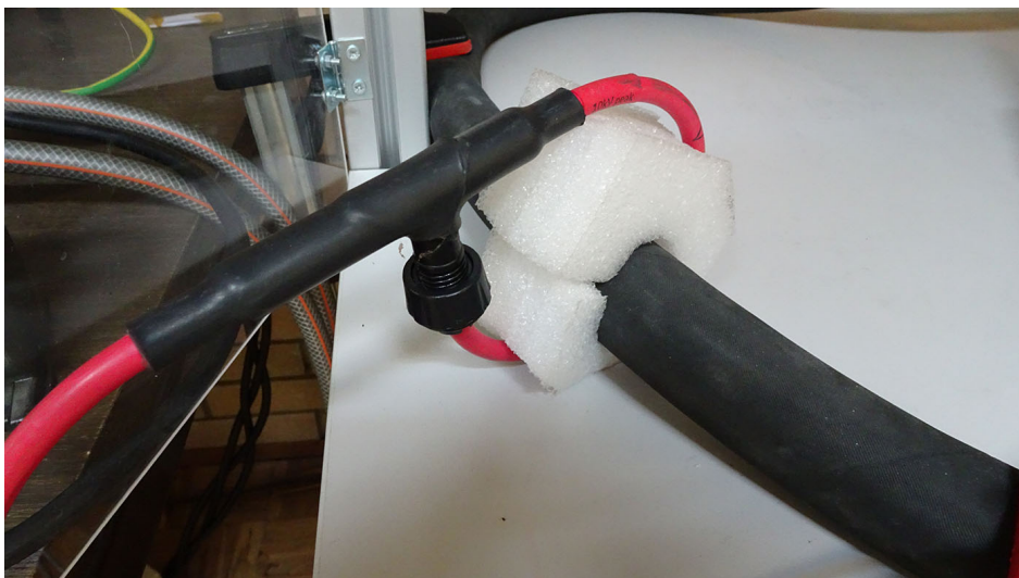
Slika A.3: Tuljavica Rogowskega, ki je del merilnega sistema PEM CWT 3 LFR
