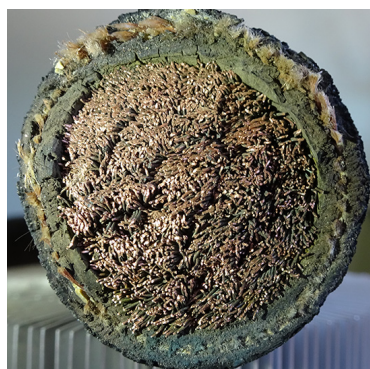
Slika 3.18: Prerez bremena: finožična vodno hlajena pletenica premera 2,5 cm
