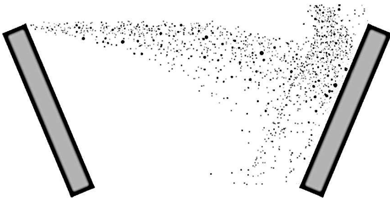
Abb. 109: DEM-Darstellung des Sichtradschaufelzwischenraumes mit Partikeldarstellung bei 9.000 \text{ min}^{-1} und einer Gutbeladung von 0,33 \text{ wt}\% [53]
