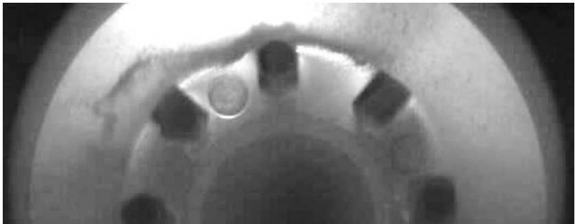
Abb. 137: Bild des Hold-up's um das Sichtrad bei hoher Konzentration nahe der äußeren Kante des Sichtrades, umgeben von einer diffuseren Zone [48].
