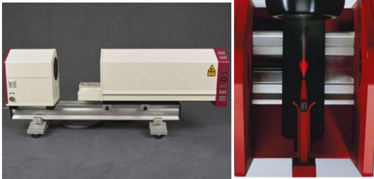
Abb. 26: Darstellung eines Helos KR Lasergraulometers (links) sowie der Messzone mit Laser (rechts) [Simpatec.de]
