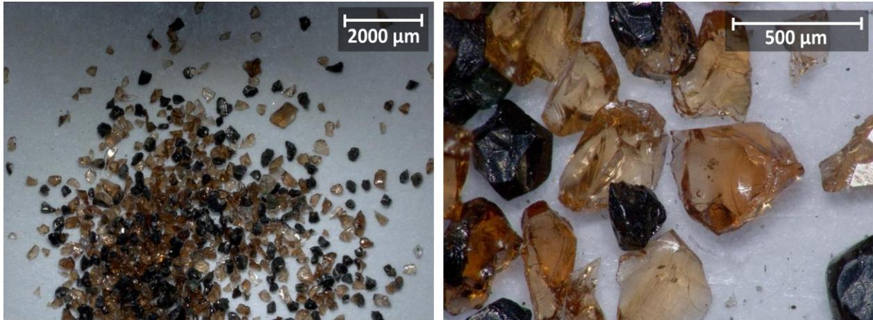
Abbildung III.1: Abrasivpartikel, die zum Schnitt in der WASS-Technik verwendet werden
