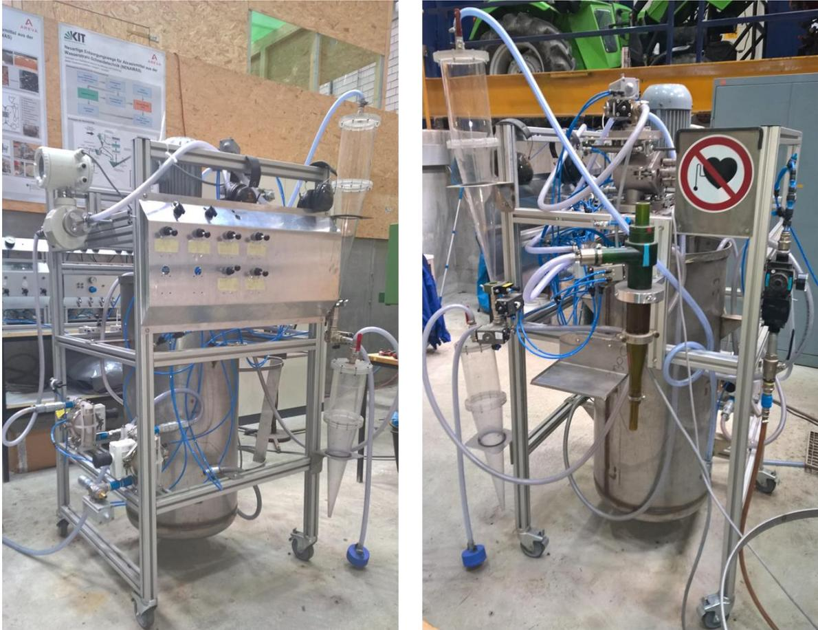
Abbildung II.2: Separationsprototyp zur magnetischen Sortierung der WASS-Korngemische
