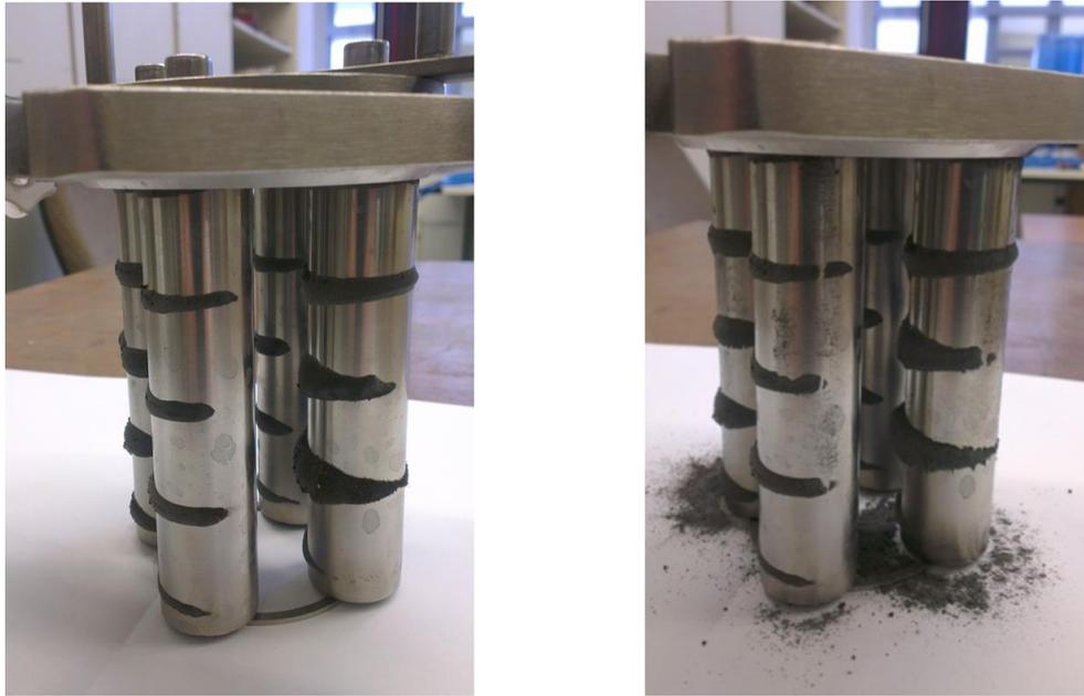
Abbildung II.7: Separationsergebnis des WASS-Gemisches mittels Stabmagnetfilter vor (links) und nach (rechts) dem Entfernen der Magnetstäbe
