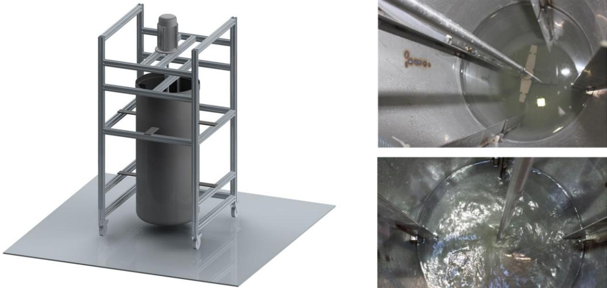
Abbildung II.3: Suspensionsmischer als CAD-Zeichnung (links) und im Einsatz (rechts)
