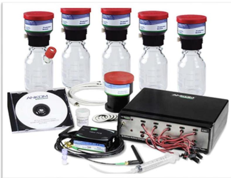
Questa apparecchiatura innovativa, è dotata di un sistema automatizzato in grado di rilevare e quantificare la pressione del gas prodotto in seguito alla degradazione fermentativa di un alimento. Lo strumento comprende: a) un set di 50 bottiglie accompagnato da b) un corrispettivo numero di moduli “attivi”; c) un modulo “zero”; d) una centralina wireless denominata “base coordinator”.
