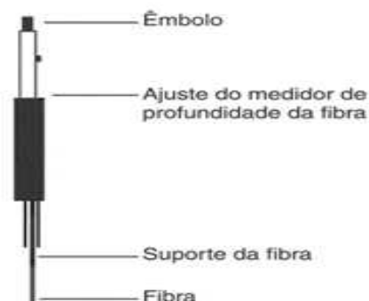
Figura 3 – Dispositivo utilizado em SPME (adaptado de [81])
