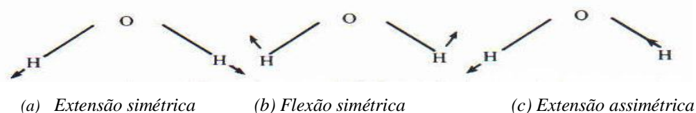
Figura 9: As três vibrações fundamentais da molécula de água. O movimento do átomo de oxigénio, que deve ocorrer para manter estacionário o centro da gravidade da molécula, é aqui ignorado (Banwell, 1983)
