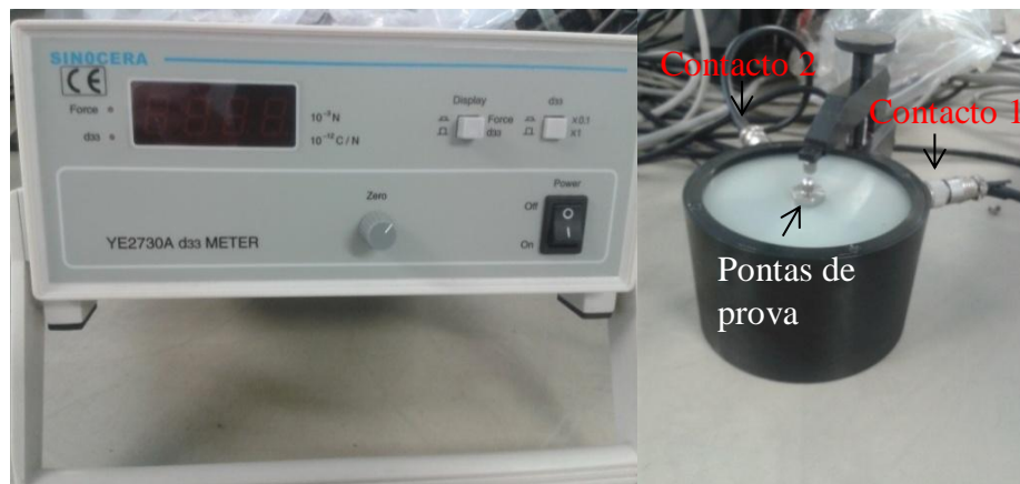
Figura 17 - d_{33} Meter APC YE2730A com porta-amostras. O porta-amostras é composto pelos contactos que controlam a força e frequência da força aplicada (contacto 1) e o sinal elétrico obtido nos terminais das pontas de prova (contacto 2).
