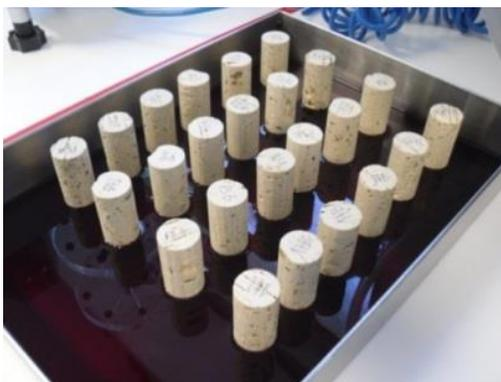
**Figura 17** - Exemplo de 4 ensaios de capilaridade a decorrer.
