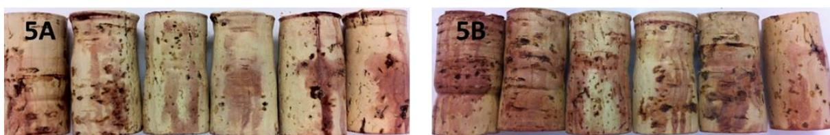
**Figura 26** – Rolhas dos ensaios 5A e 5B submetidas ao teste de absorção em garrafa.
