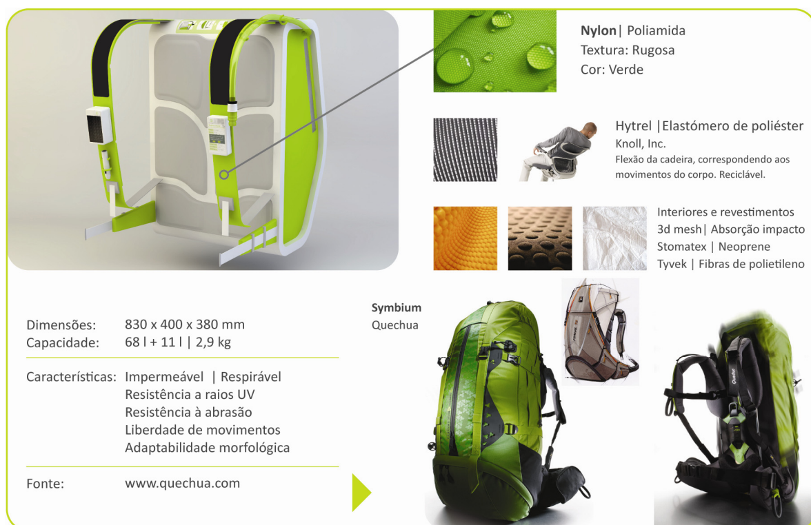
Fig. 6.95: Possibilidades materiais para a estrutura e revestimento das alças do objecto em estudo. Fonte: dados articulados pelo autor (2012).
