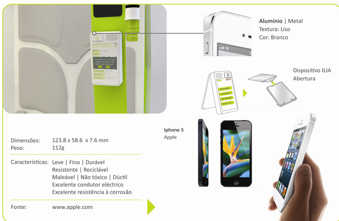
Fig. 6.97: Material sugerido para a estrutura principal do dispositivo ILIA e lanterna e exemplo de aplicação. Fonte: dados articulados pelo autor (2012).
