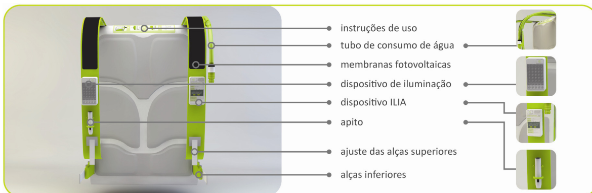
Fig. 6.71: A configuração das alças e componentes nelas integrados. Fonte: o autor (2012).
