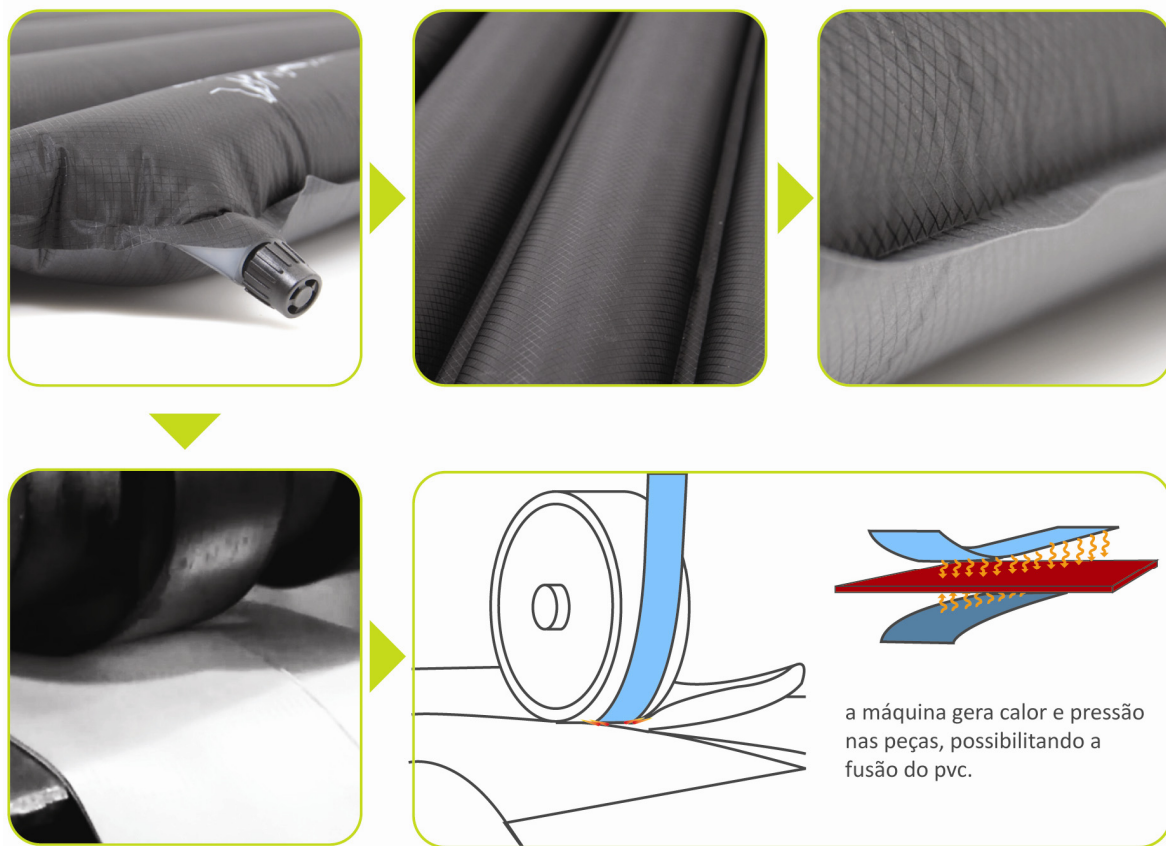
Fig. 6.45: Método de produção de colchões insufláveis. Fonte: dados articulados pelo autor (2012).
