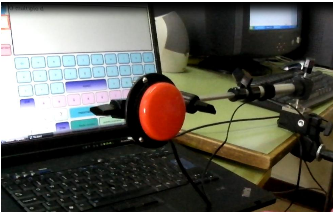
Figura1 – O equipamento da aluna: um computador portátil, com software Grid 2 instalado, com um manípulo, braço articulado e interface Improman.
