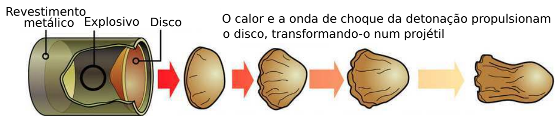
Figura 1.4: Esquema representativo do processo de formação de um EFP (Laboratório de Pesquisa da Força Aérea (AFRL), Global Security , desenhado por Hulteng e Treible [36]).
