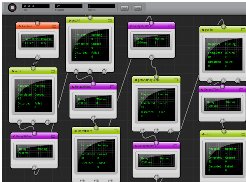
Figura 33 – Teste de carga ao serviço de exercícios
