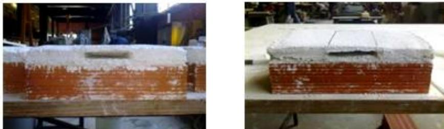
Figura 22 – Simulação de descontinuidade entre camadas de reboco.
