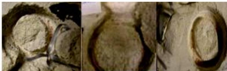
Figura 94 – Zona não consolidada: rotura adesiva na interface entre camadas de emboço.
