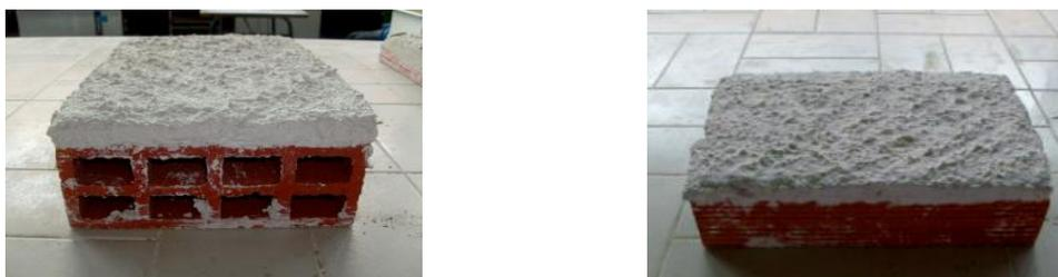
Figura 19 – Execução da 1ª camada de emboço sobre o chapisco.
