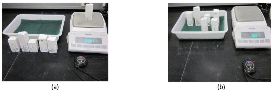
Figura 18 – (a) Determinação do peso seco de cada provete; (b) realização do ensaio de capilaridade.
