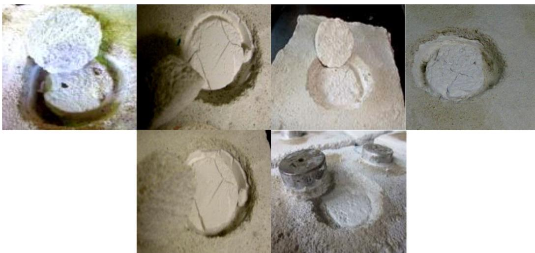
Figura 90 – Zona de consolidação: rotura adesiva na interface grout/2ª camada de emboço.
