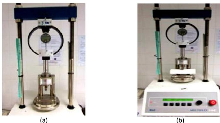
Figura 15 – (a) Máquina universal de ensaios e célula de carga de 3kN; (b) Ensaio de resistência à flexão realizado sobre os provetes prismáticos.
