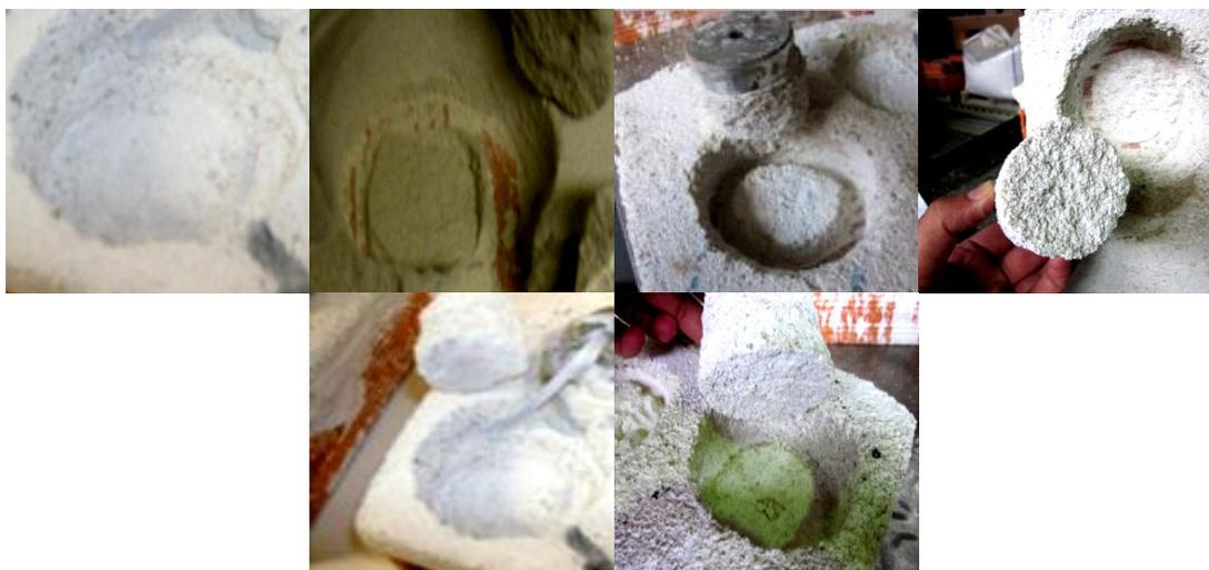
Figura 93 – Zona não consolidada: rotura a coesiva no seio da 1ª camada de emboço.
