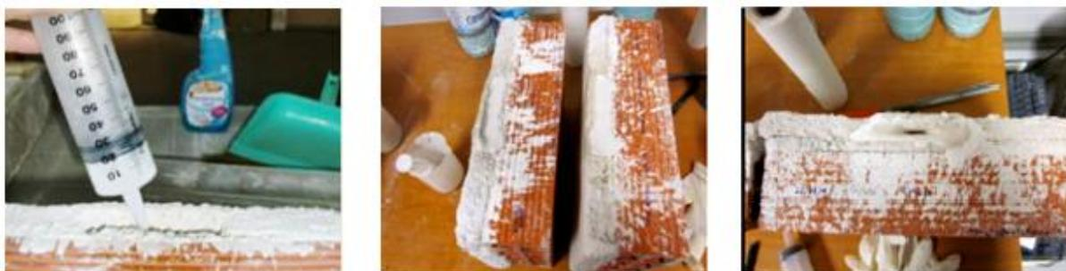
Figura 24 – Injeção do *grout*.
