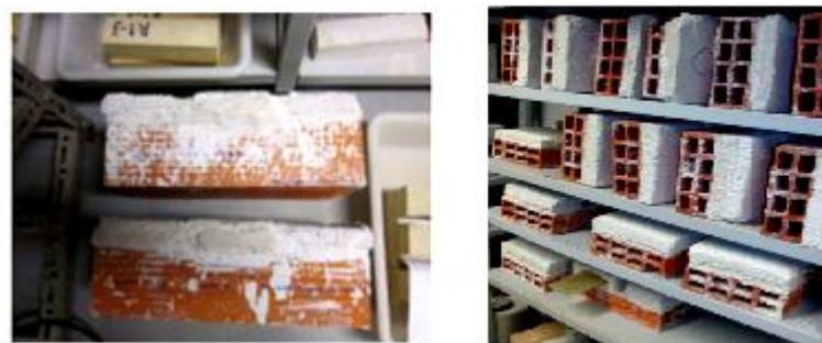
Figura 25 – Referenciação dos provetes e respetiva colocação no interior da sala condicionada a 21°C e 65% HR.
