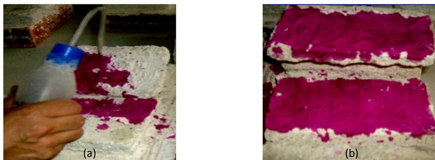
Figura 36 – (a) Pulverização da superfície de destacamento com solução de fenolftaleína a 0,2% de concentração; (b) Coloração rosa das zonas não carbonatadas.
