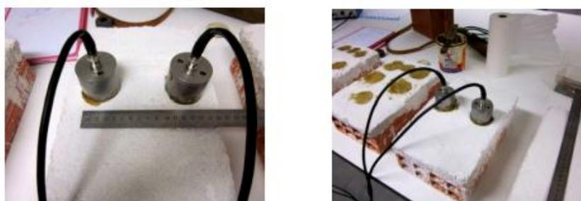
Figura 37 – Medição da distância entre emissor e recetor e realização do ensaio de propagação de ondas ultrassónicas sobre a zona de reboco e sobre a zona onde se procede à injeção do *grout*.
