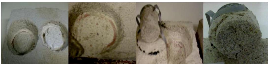
Figura 95 – Zona não consolidada: rotura adesiva na interface suporte/1ª camada de emboço.
