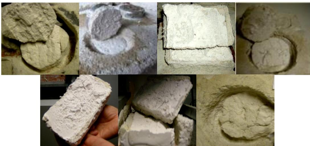
Figura 91 – Zona de consolidação: rotura coesiva no seio da camada de *grout*.
