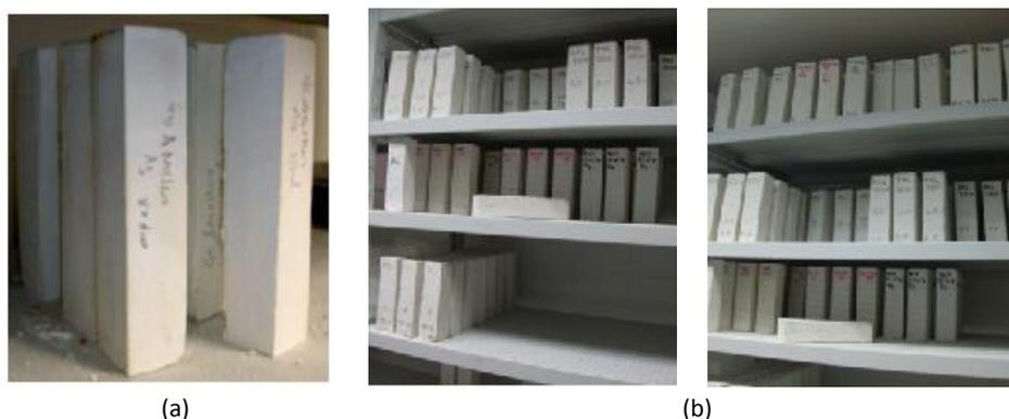
Figura 14 – (a) Provetes prismáticos colocados na vertical devidamente referenciados; (b) Provetes prismáticos no interior da sala condicionada durante o processo de cura.
