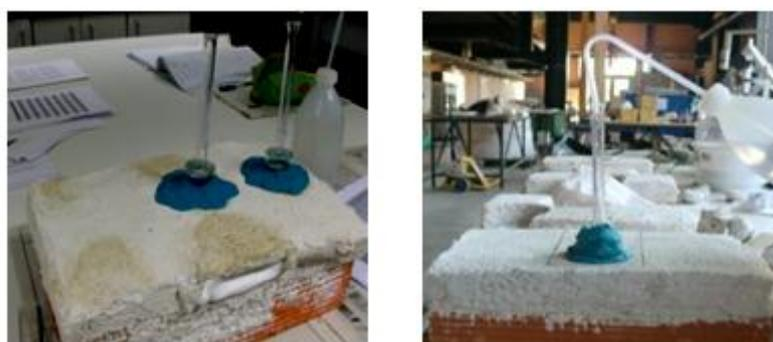
Figura 26 – Ensaio de permeabilidade à água sob baixa pressão (Tubos de Karsten), na zona de reboco e na zona com injeção de *grout*.
