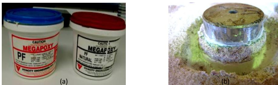
Figura 27 – (a) Cola epoxídica usada para a colagem das pastilhas ao substrato; (b) Pastilha já colada ao substrato.
