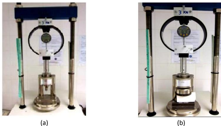
Figura 17 – (a) Máquina universal de ensaios e célula de carga de 3kN; (b) Ensaio de resistência à compressão realizado sobre os meios provetes resultantes do ensaio de flexão.
