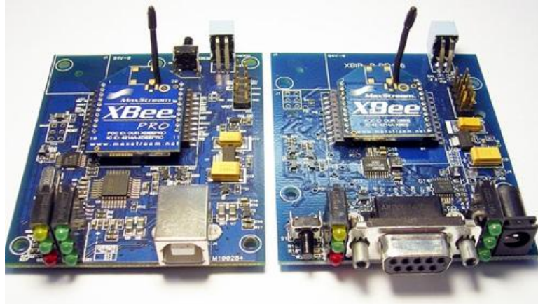
Figura 15 - Placas de desenvolvimento para os módulos XBee
