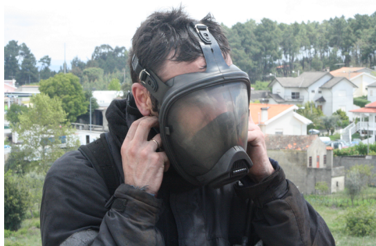
Figura 4.1: Peça facial do ARICA ajustada ao operador
