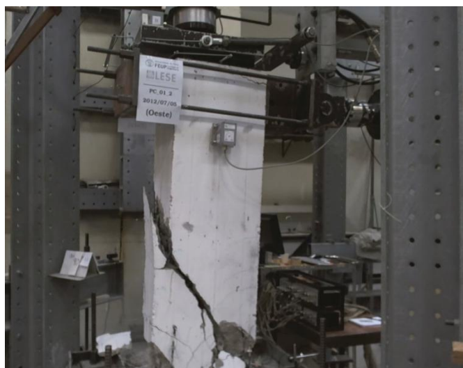
Figura 8 Rotura abrupta do pilar PC01_N02
