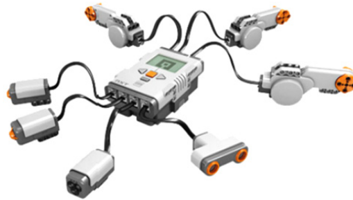
Figura 5: Componentes LEGO mindstorms NXT 2.0
