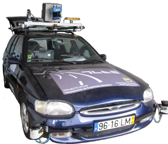
Figura 1.2: AtlasCar, modelo Ford Escort SW equipado com sensores.
