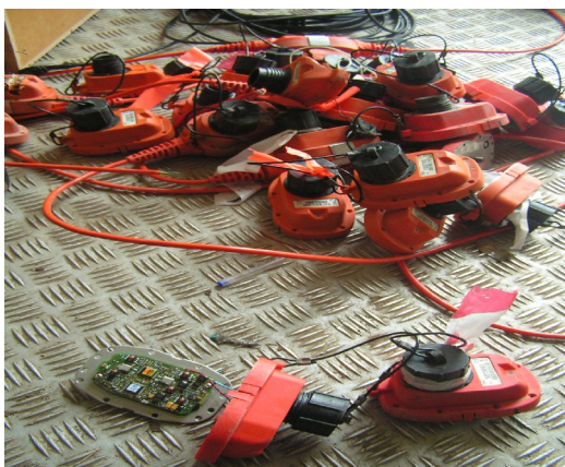
Figura 4.22- FDU's recolhidos do campo que aguardam na oficina para serem reparados pelo electricista.
