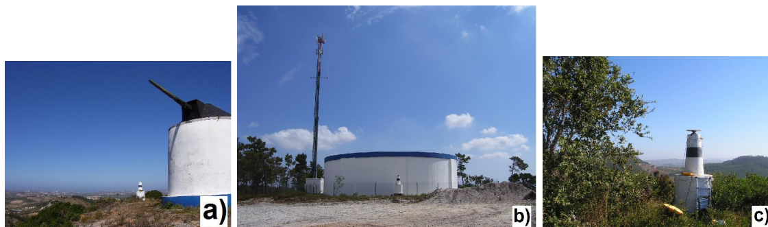
Figura 3.28 – a) Moinho de vento interfere na utilização do marco geodésico; b) Depósito de água e Antena interferem na utilização do marco geodésico; c) Árvores interferem na utilização do marco geodésico.
