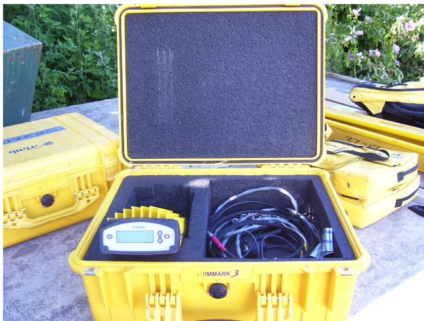
Figura 3.12 - Trimmark III rádio base/repetidor.
