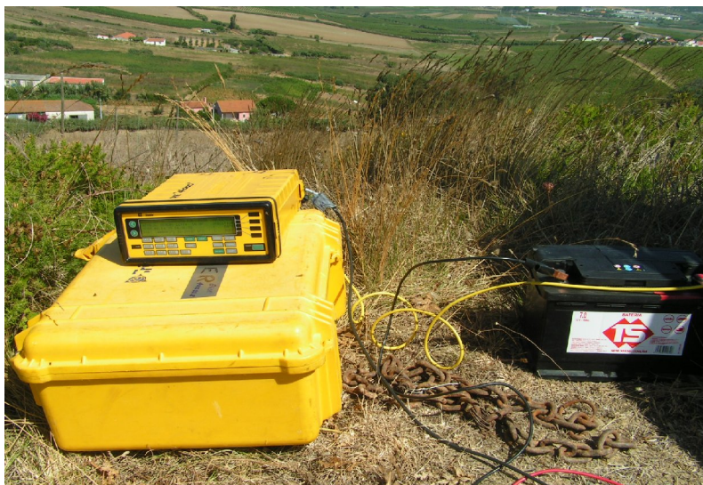
Figura 3.9 – GPS Trimble 4000 numa sessão estática sobre um marco geodésico.
