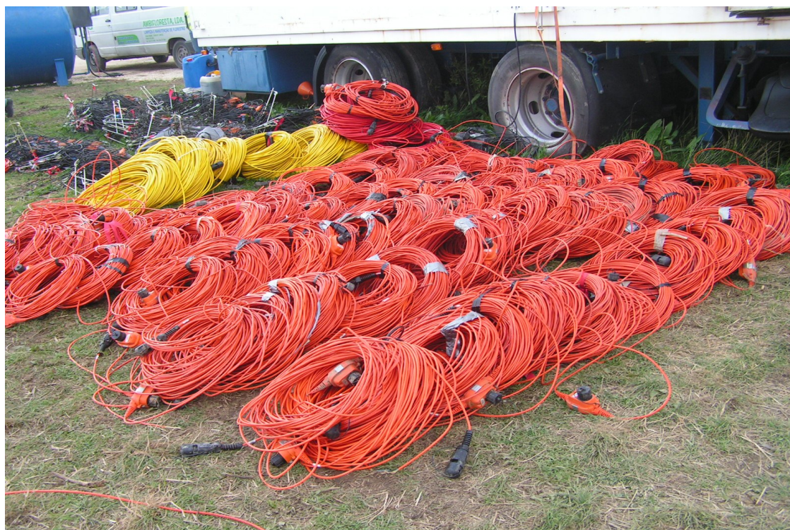
Figura 4.26: Os diferentes tipos de cabos utilizados na aquisição sísmica.
