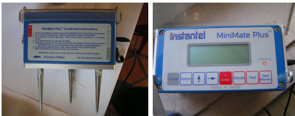
Figura 4.9- Aparelho MiniMate Plus, para monitorização de vibrações. Os espigões do aparelho pertencem aos geofones. O painel de controlo permite a alteração de parâmetros e outras configurações.
