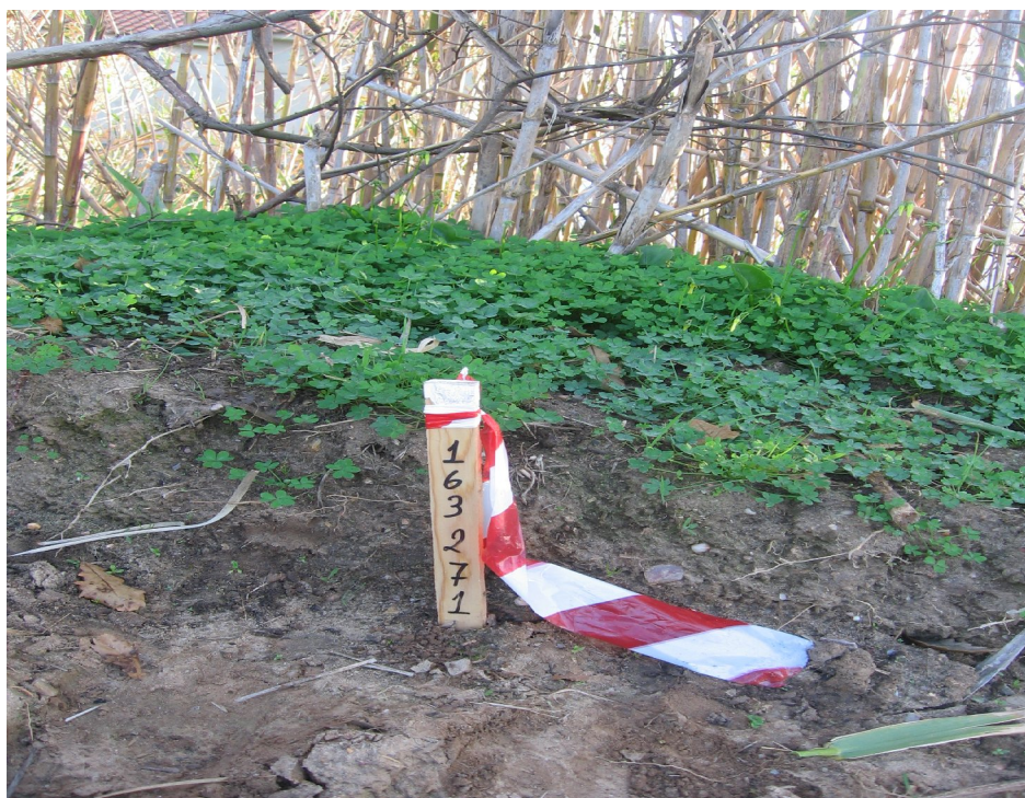
Figura 3.27 – Marcação no terreno de uma estação nivelada pela topografia.
