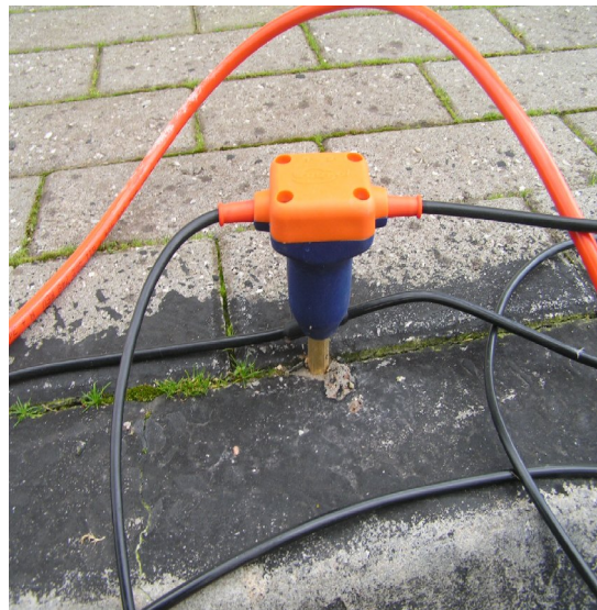
Figura 4.21-Geofone “plantado” no canto do passeio (ampliação da figura 4.16).
