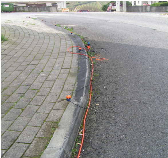
Figura 4.20- Ligado ao cabo laranja Sercel temos um grupo de 6 geofones “plantados” em linha (geometria alternativa ao “S”) devido às condições do terreno.
