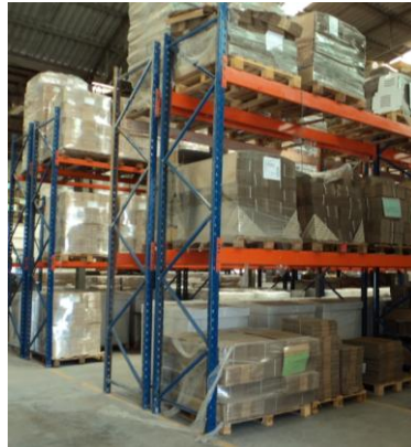
Figura 8 – Estrutura APR – Imagem armazém de Aradas
