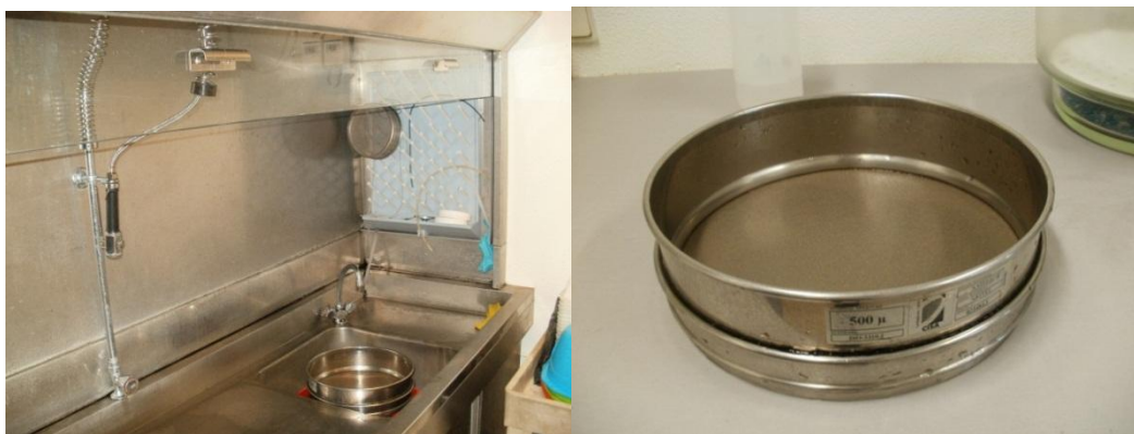
Figura 6 – Hotte para a lavagem das amostras, à esquerda; crivo de 500 µm à direita utilizado para a lavagem das amostras
