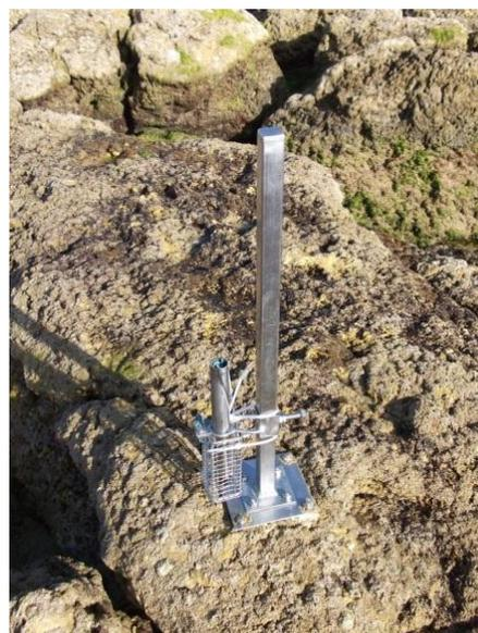
**Figura 14 – *Pressure Transducer* (PT) – transdutor de pressão.**
