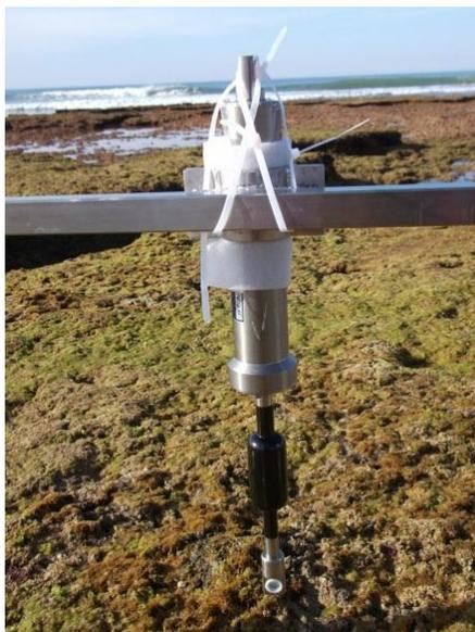
**Figura 13 – *Electromagnetic Current Meters* (ECM) – correntómetro eletromagnético.**
