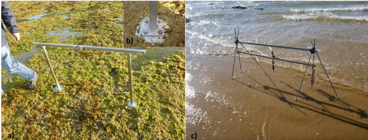
**Figura 12 – a) Fixação das estruturas à plataforma rochosa. b) Pormenor da fixação na plataforma rochosa. c) Estrutura enterrada na areia.**
