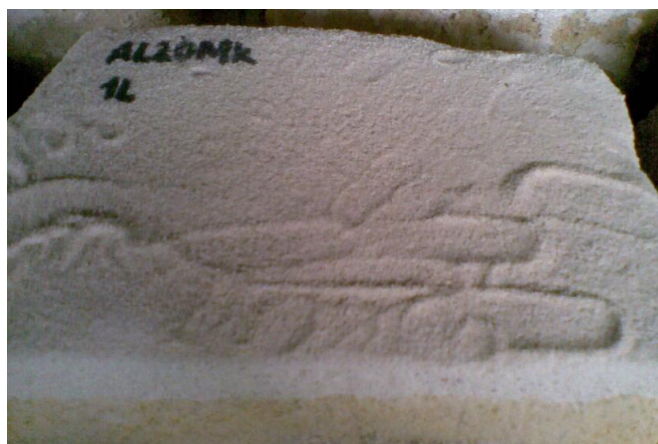
Figura 49. Partículas observadas na superfície da argamassa após ensaio de envelhecimento acelerado (Matos, 2012)
