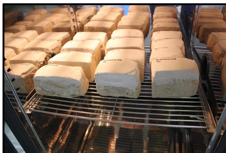
Figura 36. Blocos de adobe submetidos aos ciclos de envelhecimento (Matos, 2012)
