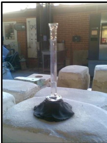
Figura 29. Ensaio de absorção de água a argamassa em bloco de adobe (Matos, 2012)
