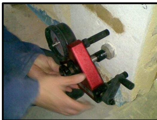
Figura 32. Ensaio de “pull-off” a argamassa em parede de adobe (Matos, 2012)
