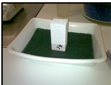
Figura 28. Ensaio de capilaridade (Matos, 2012)
