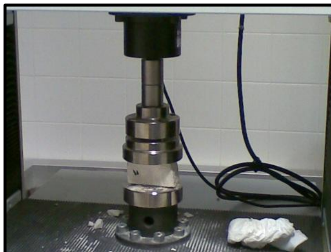
Figura 23. Ensaio à compressão (Matos, 2012)
