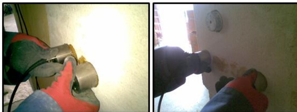
Figura 21. Ensaio com o PUNDIT nas argamassas em parede de adobe (Matos, 2012)
