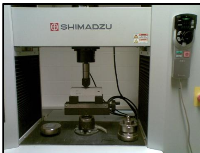
Figura 22. Ensaio à flexão (Matos, 2012)
