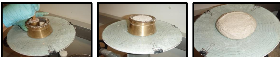
Figura 19. Verificação do valor de espalhamento (Matos, 2012)
