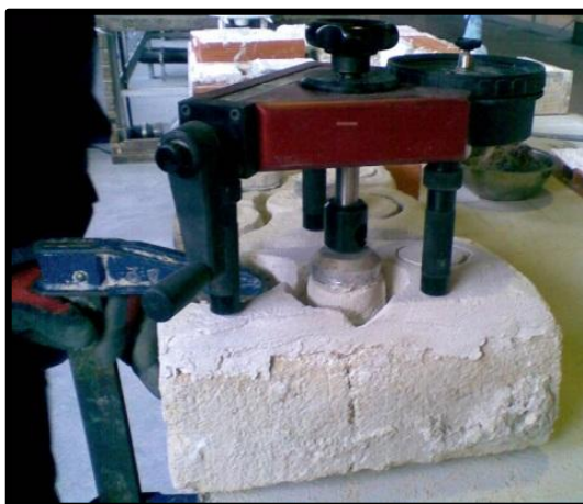
Figura 31. Ensaio de “pull-off” a argamassa em bloco de adobe (Matos, 2012)
