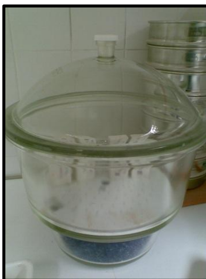
Figura 27. Amostras no exsicador (Matos, 2012)
