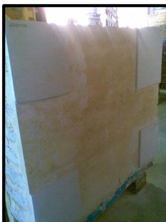
Figura 17. Parede de adobe com as diferentes argamassas aplicadas (Matos, 2012)
