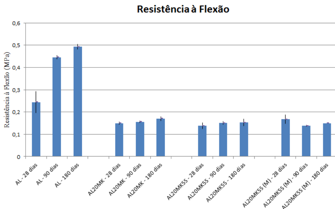
Figura 42. Comparação da resistência à flexão das argamassas nas diferentes fases de cura
