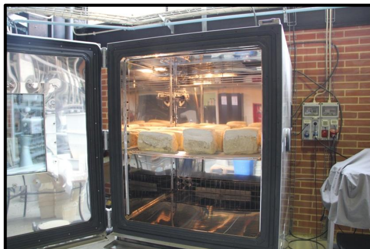
Figura 35. Câmara de imposição de ciclos para envelhecimento acelerado (Matos, 2012)
