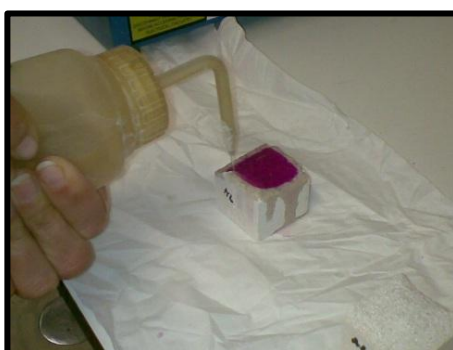
Figura 24. Estado de carbonatação em provete de argamassa (Matos, 2012)
