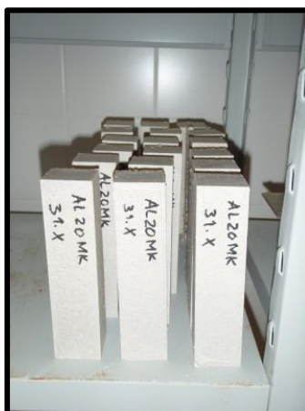
Figura 13. Provetes em cura na câmara climática a 65\pm 5\% HR e 20\pm 2^\circ\text{C} (Matos, 2012)
