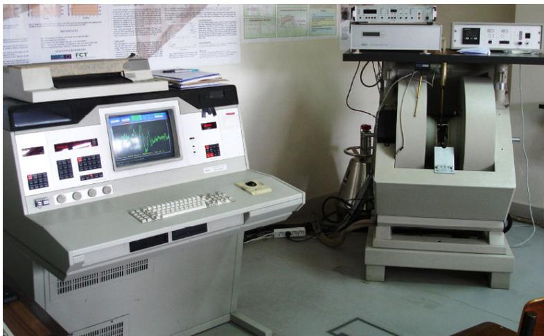
**Figura 7 - Espectrómetro EPR (Bruker ESP 300) utilizado na medição das doses absorvidas pela alanina, do Departamento de Física da Universidade de Aveiro.**
