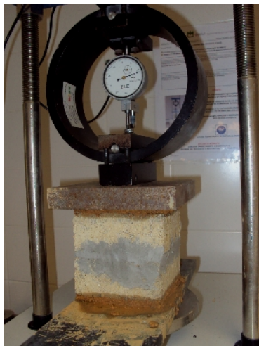
Fig. 3. Ensaio de resistência à compressão dos blocos.
