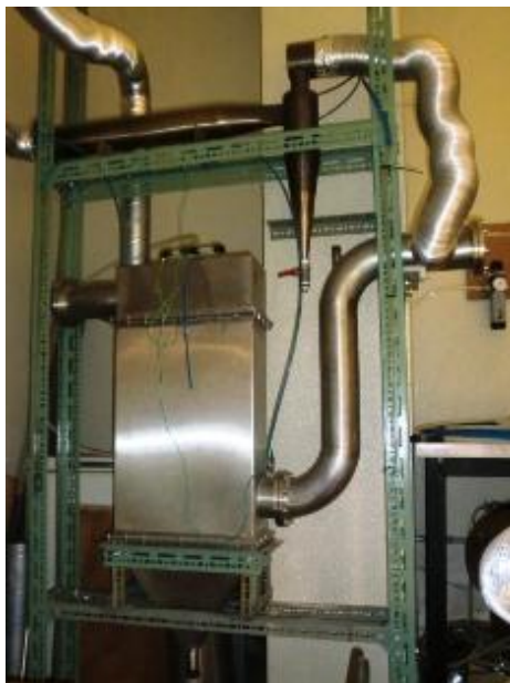
Figura 3-11 – Sistema de despoejamento utilizado nas experiências de combustão de biomassa no leito fluidizado.
