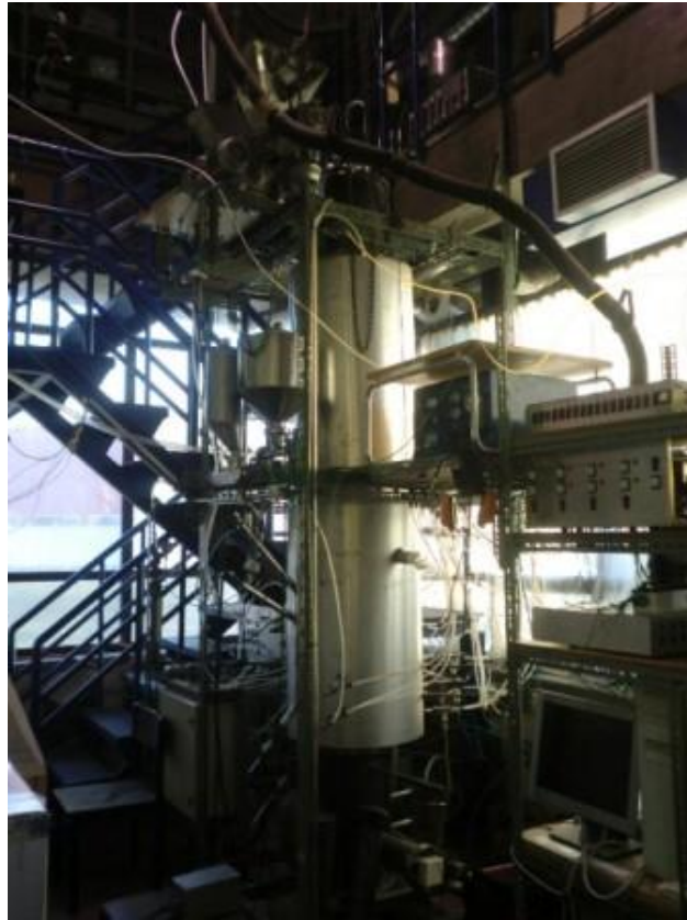
Figura 3-1 - Sistema experimental de combustão – aspecto do reator à escala piloto.
