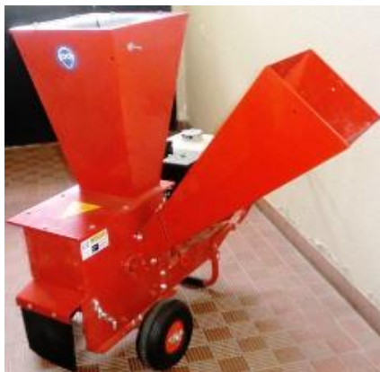
Figura 3-9 – Destroçador usado para produzir estilha a partir de resíduos de biomassa florestal.
