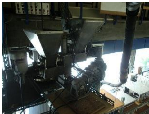
Figura 3-3 - Sistema de alimentação dos combustíveis, o alimentador de lamas (à esquerda) e o alimentador de biomassa (à direita).
