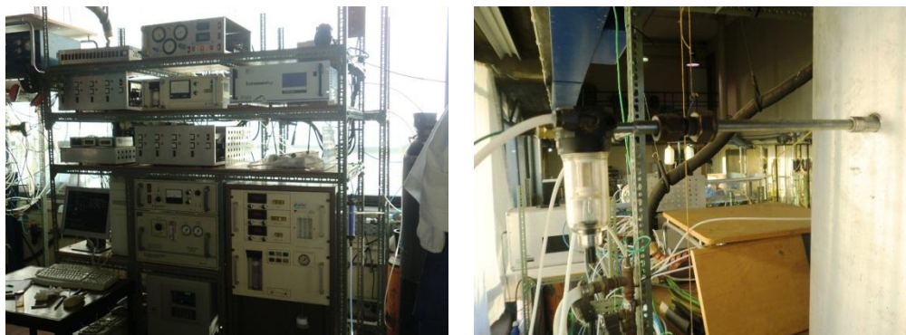
Figura 3-7 - Sistema de amostragem e análise gasosa (à esquerda) parte anterior de uma sonda de amostragem (à direita).
