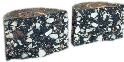
Figura 22. Provete que sofre corte bem definido por tracção indirecta.
