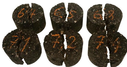
Figura 41. Provetes sujeitos a ensaio de tracç o indirecta com rotura bem definida.
