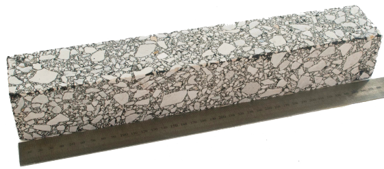
Figura 31. Provete prismático usado no ensaio de resistência à fadiga - 380x60x60 (mm).
