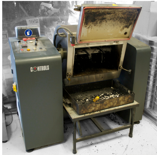
Figura 37. Misturadora automática com capacidade para 30 l (cortesia da Probigalp).
