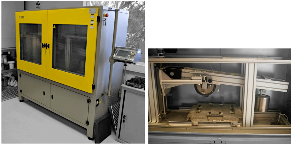
Figura 12. Aparelho para ensaio de pista e pormenor do seu interior (cortesia da Probigalp).
