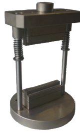
Figura 9. Estabilómetro para aplicação de tracção indirecta (cortesia da Probigalp).
