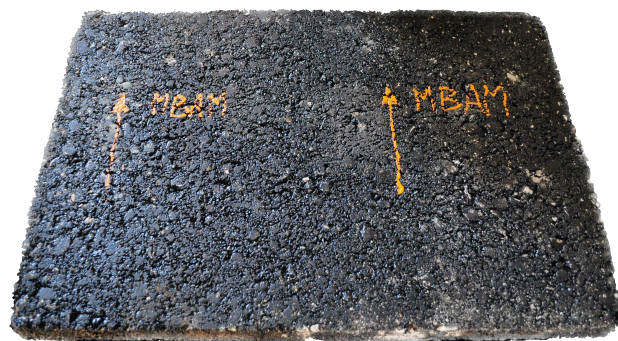
Figura 23. Laje moldada em laboratório para ensaios de pista.
