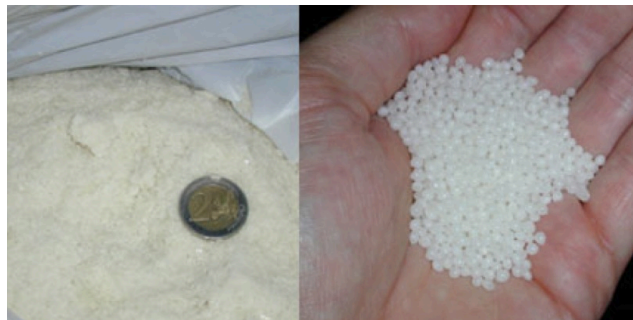
Figura 17. Sasobit® sob a forma de flocos e grânulos (D'Angelo et al. , 2008).
