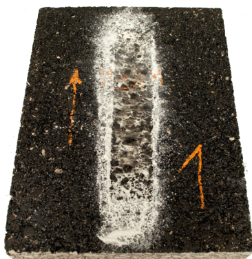
Figura 24. Laje sujeita a ensaio de pista.
