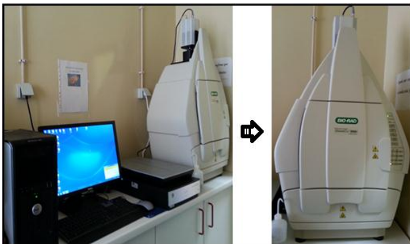
Figura 13. Equipamentos de visualização dos resultados da Electroforese, ChemiDoc™ XRS+ System Image Lab™ da marca BIORAD.
