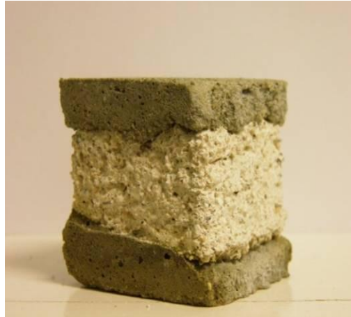
Figura 61. Provete para ensaio de resistência à compressão com confinamento
