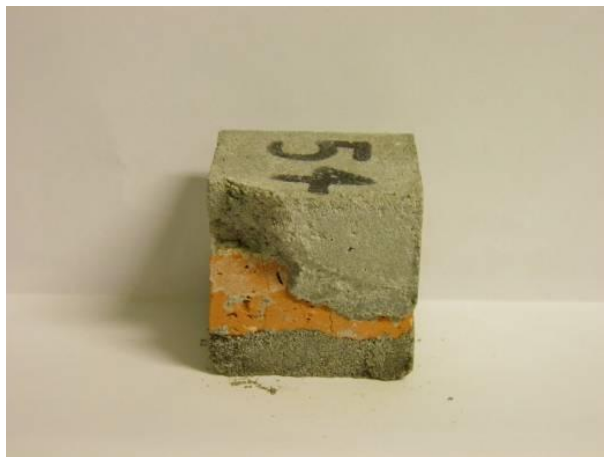
Figura 69. Provete para ensaio de resistência à compressão da amostra CV-RP-MN2
