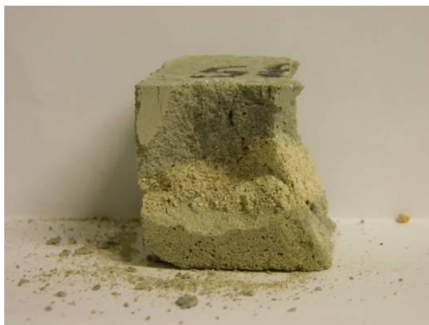
Figura 72. Amostra CV-SV-V, após rotura, ensaio de resistência à compressão
