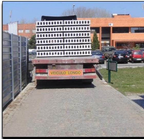
Figura 18: Transporte das lajes alveolares para a obra (Fonte própria, 2012)
