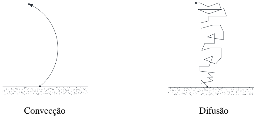
Figura 17 – Esquema dos tipos de percurso que as partículas podem descrever ao longo de uma coluna de água (Nielsen, 1992).
