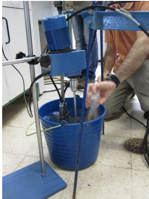
Figura 18 – Ensaio com OBS para obter as equações de calibração.
