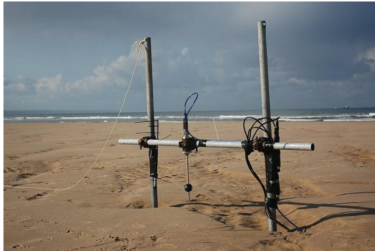
Figura 3 – Estrutura em “H” com a instalação dos equipamentos (Bezerra et al , 2010).
