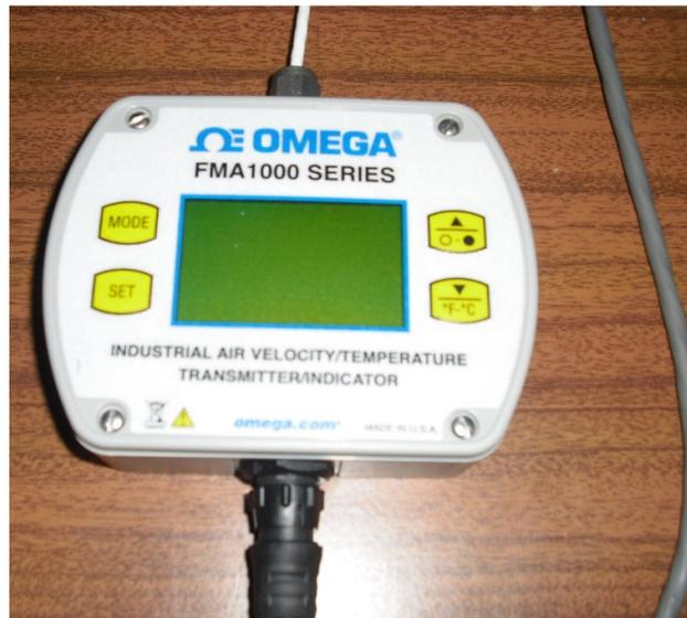
Figura 254: Transmissor de velocidade Omega
