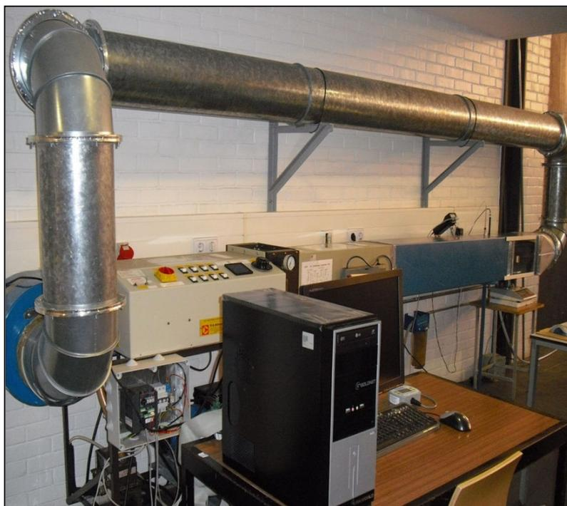
Figura 15: Instalação experimental de secagem convectiva
