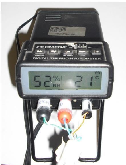
Figura 252: Termo-higrómetro Omega
