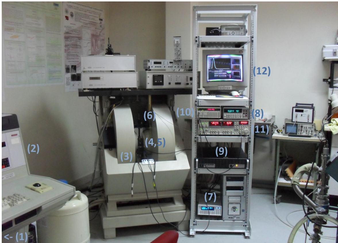
Figura 11 – Arranjo experimental usado nas medições do e feito ME direto.
