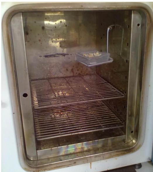
Figura 29 – Estufa de secagem com a amostra colocada sobre a estrutura de ligação à balança no exterior
