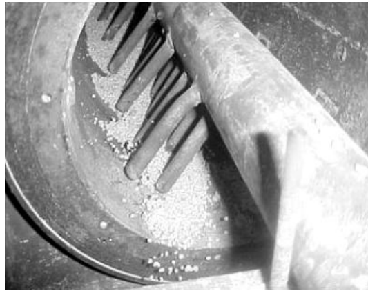
Figura 6 – Secador rotativo do tipo roto-fluidizado (Arruda, 2008).
