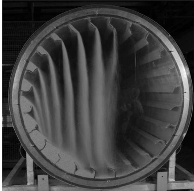
Figura 19 – Imagem transversal de um secador rotativo com sobrecarregamento (Ajayi & Sheehan, 2012)
