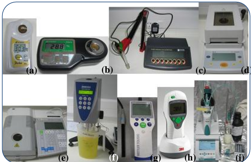
Figura 7 - Equipamentos utilizados: (a) refratômetro Atago® pocket PAL-α (0 – 85%); (b) refratômetro Atago® palett Pr-201α (0 – 60 %); (c) medidor de pH e temperatura HI 2221 - Hanna® Instruments ; (d) analisador de humidade Sartorius® - MA 35 ; (e) analisador de humidade HR 73- Mettler® Toledo ; (f) viscosímetro Brookfield® DV-II+Pro ; (g) condutivímetro Serie® InLab 738 ; (h) luminômetro 3M™ Clean Trace™ ; (i) titulador automático 848 Titrino Plus – Metrohm®
