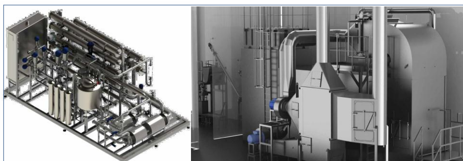
Figura 4 - Equipamento de ultrafiltração e Spray Drying. Adaptado de: http://www.sanovogroup.com (18)
