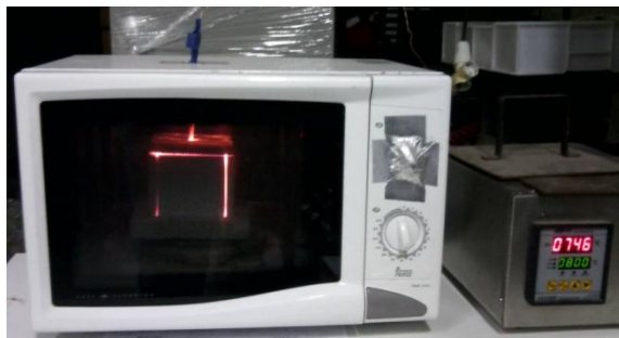
Figura 3.7 – Forno de micro-ondas doméstico utilizado, adaptado a um controlador externo com um termopar.
