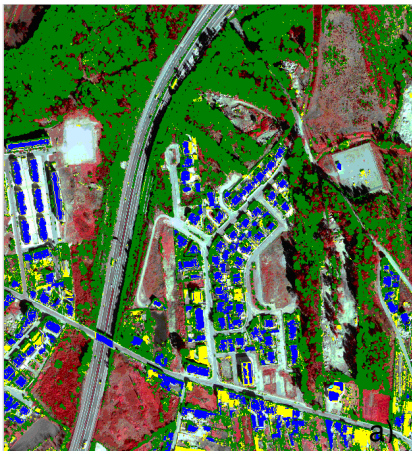
Figura 4: Resultados obtidos com a metodologia proposta: a) Classificação final do MDS (azul edifícios, amarelo outros objectos e verde-escuro vegetação alta); b) MDT final depois de terem sido removidos os objectos não pertencentes ao terreno.
