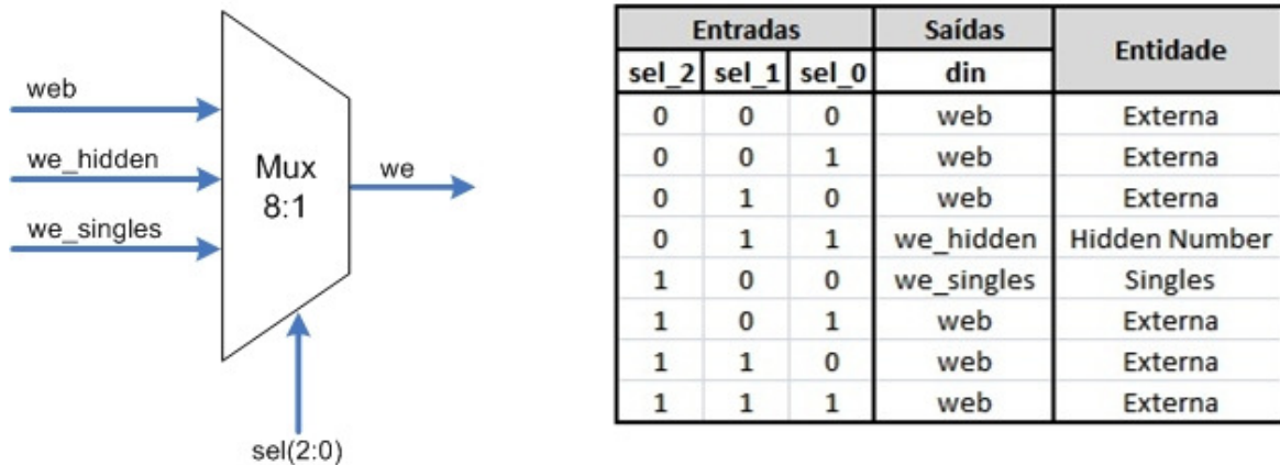
Figura 5.34 – Interface do multiplexer de controlo do solucionador simples e respetiva tabela de verdade
