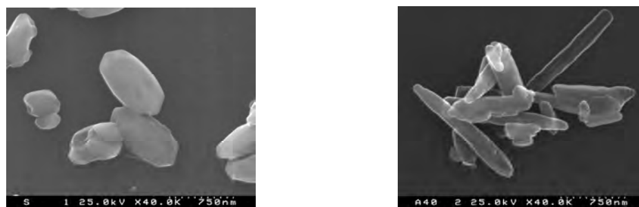
Figura III.2.2.3 – Imagens obtidas por microscopia electrónica de varrimento (SEM) de partículas de carbonatos de cálcio precipitado de hábito escalenoédrico (PCC-E) (à esquerda) e acicular (PCC-A) (à direita).
