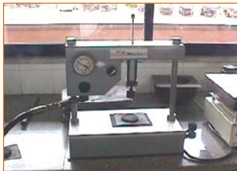
Figura 57. Equipamento para ensaio à coesão de microaglomerados (Bernucci et al., 2008)
