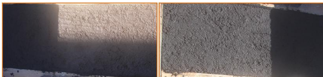
Figura 62. Microaglomerado efectuado com a emulsão E8, e a fórmula de trabalho “e”, logo após aplicação (foto à esquerda), e um dia após aplicação (foto à direita)
