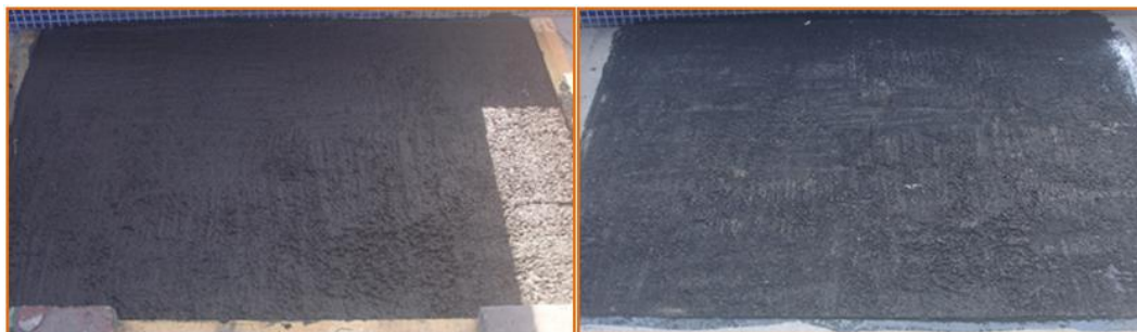
Figura 61. Microaglomerado efectuado com a emulsão E8, e fórmula de trabalho “b”, logo após aplicação (foto à esquerda), e um dia após aplicação (foto à direita)
