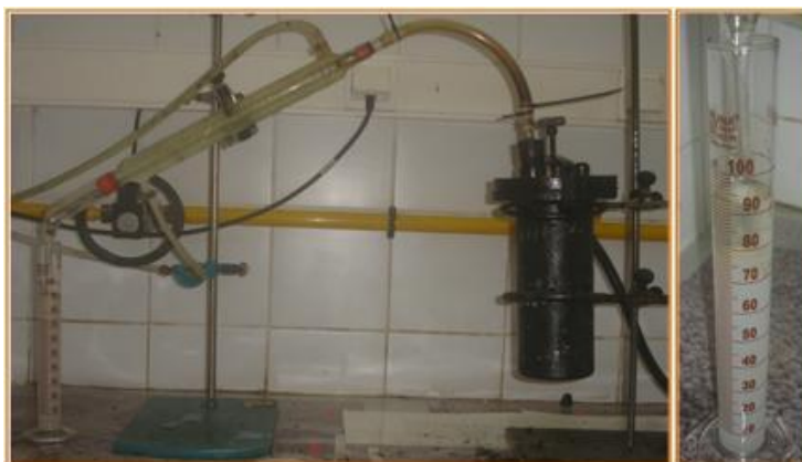
Figura 18. Processo de destilação, com destaque para a proveta contendo a água e o emulsionante evaporados
