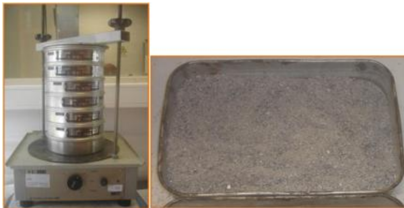
Figura 44. Peneiração automática e agregados utilizados (classe 0/4)
