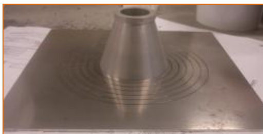
Figura 55. Cone utilizado para a avaliação da consistência da mistura
