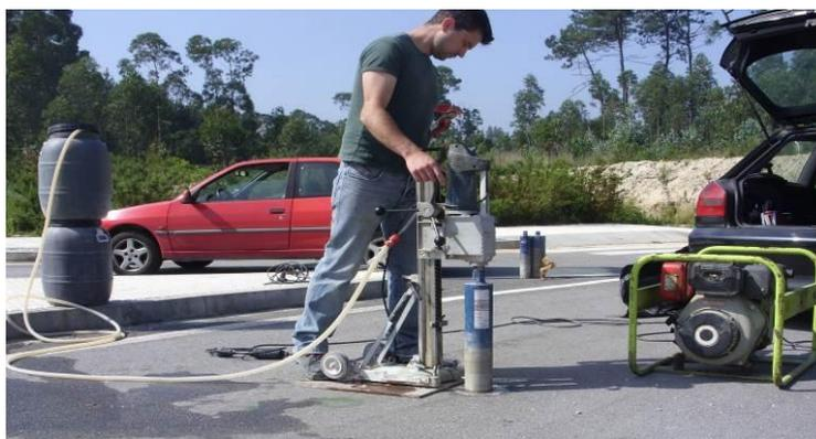
Figura 41. Equipamento utilizado na extracção de carotes.
