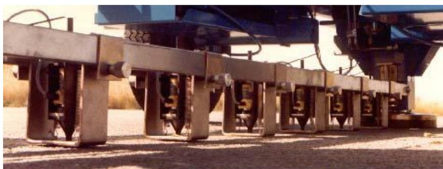
Figura 32. Ensaio FWD e respectivos geofones. (Fonte: Gurp, 2005)
