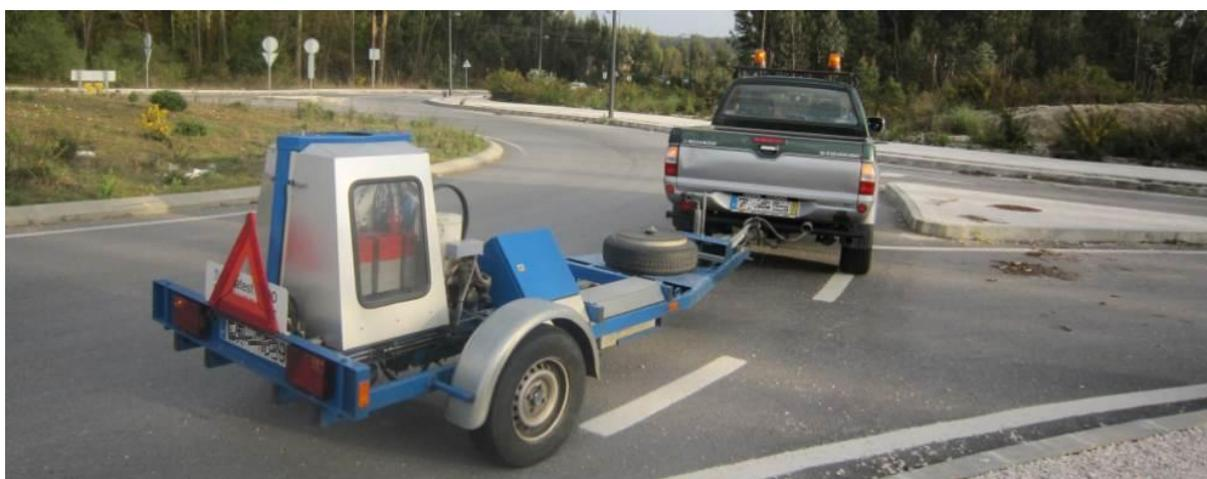
Figura 55. Deflectómetro de impacto utilizado nos ensaios.
