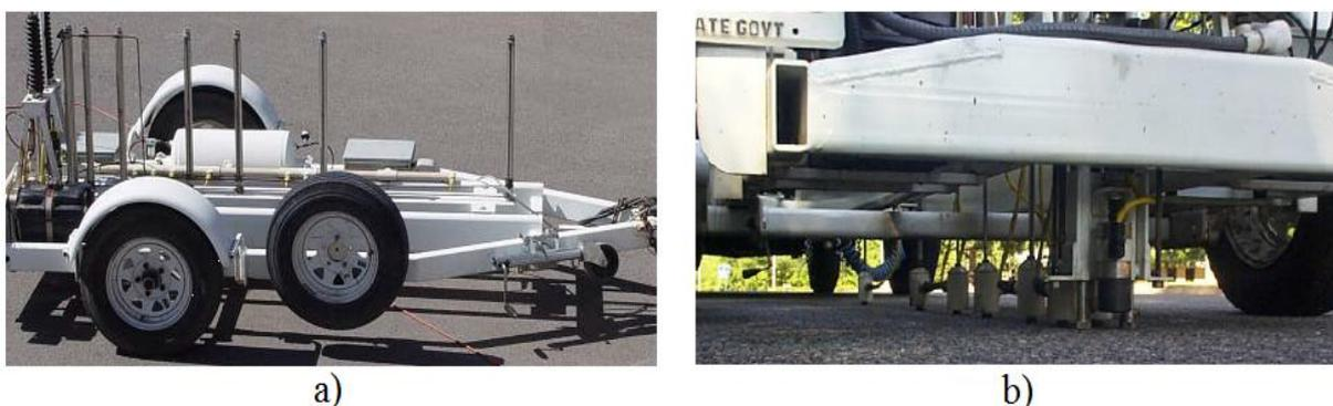
Figura 11. a) Imagem ilustrativa do equipamento SPA (Fonte: Abdallah et al., 2006) b) Transdutores e fontes de impacto em situação de ensaio. (Adaptado de: Gucunski e Maher, 2002)
