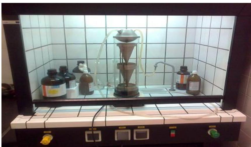
Figura 48. Imagem exemplificativa do equipamento usado para decompor as misturas betuminosas.
