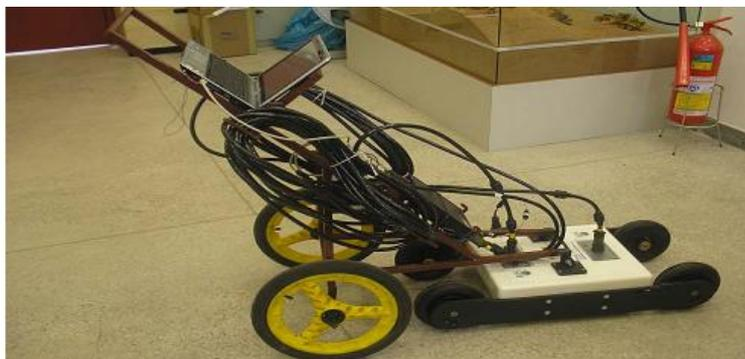
Figura 12. Exemplo dum equipamento GPR, no qual é possível distinguir os diferentes componentes enunciados anteriormente. (Fonte: Lopes, 2009)
