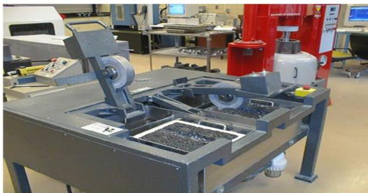
Figura 28. Imagem exemplificativa do equipamento utilizado no ensaio *Hamburg Wheel-Tracking Device*. (Adaptado: de Stuart e John S. Youtcheff, 2001)
