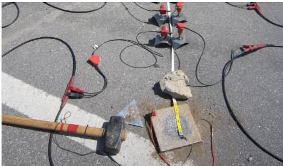
Figura 68. Fonte sísmica utilizada no ensaio.
