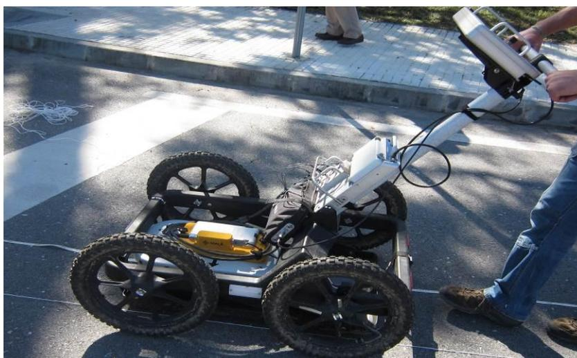
Figura 50. Equipamento utilizado na aquisição de dados Georadar.
