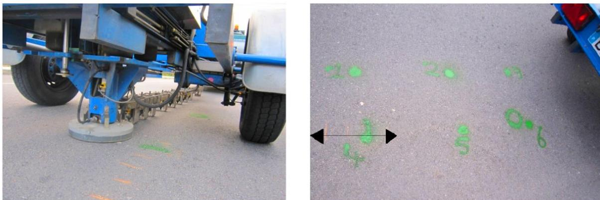
Figura 56. Realização do ensaio FWD na zona B e representação do alinhamento do ensaio protótipo de Microsísmica pela seta a preto.
