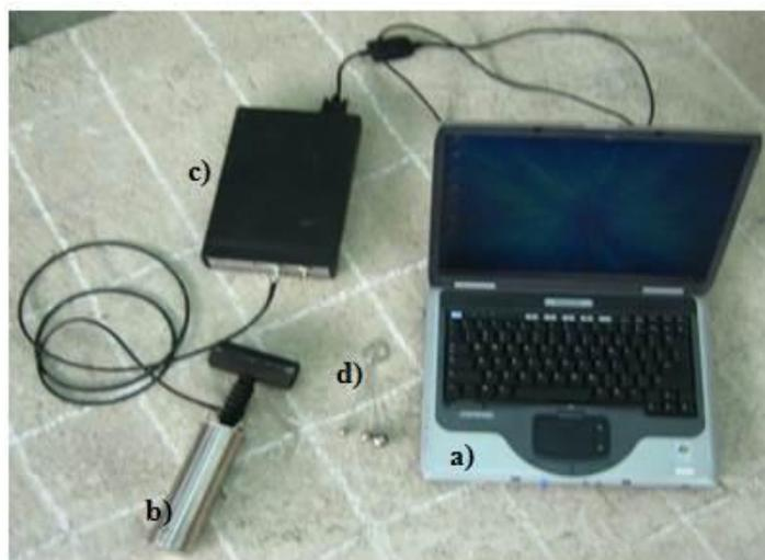
Figura 8. Componentes do método (IE): a) Computador; b) Transdutor de deslocamento; c) Unidade de aquisição de dados; d) Fonte de impacto. (Adaptado: de Aktas, 2007)
