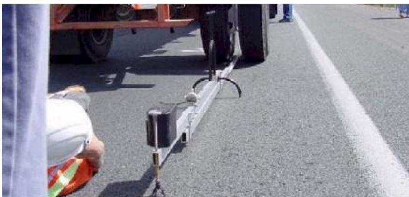
Figura 30. Ensaio com a viga *benkleman*. (Adaptado: de PGI, 2011)
