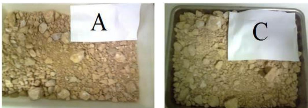
Figura 44. Fotografia do material granular recolhido na carotagem.
