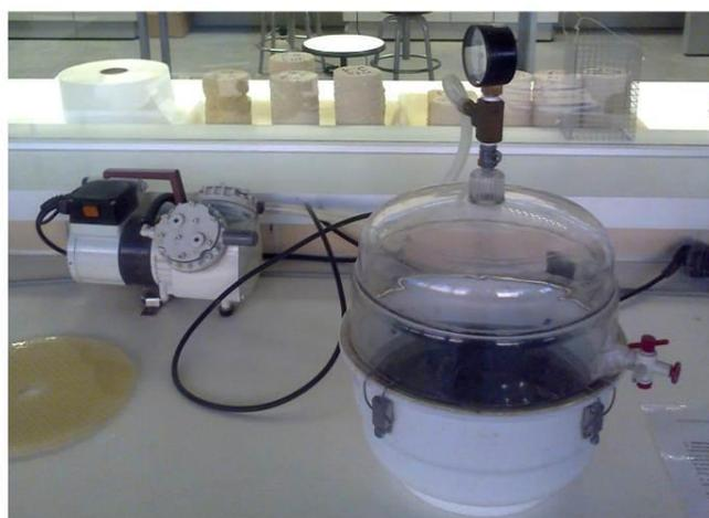
Figura 47. Picnómetro de vácuo utilizado para a determinação da baridade máxima teórica das misturas betuminosas.
