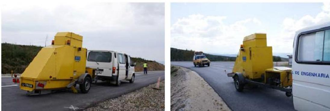
Figura 31. Deflectómetro de Impacto do LNEC. (Fonte: Alves, 2007)
