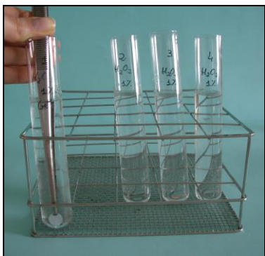
Fig. 5 – Introdução do disco de papel de filtro na solução de H_2O_2 proveniente do gelo.
