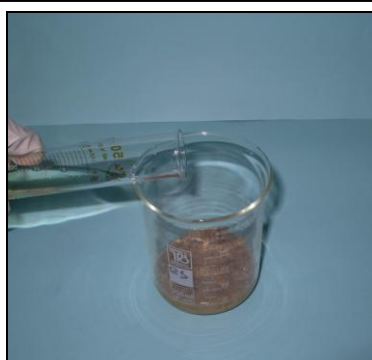
Fig. 3 – Adição da solução de extração ao gérmen de trigo.
