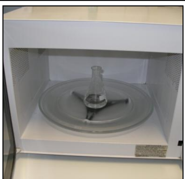
Fig. 3 – Dissolução da agarose no microondas.
