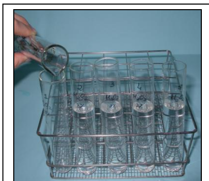
Fig. 1 – Preparação dos tubos de ensaio com a solução de H_2O_2 .
