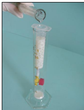
Fig. 7 – Adição do leite sobre as pérolas de alginato de cálcio com a enzima imobilizada.
