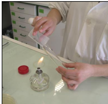
Fig. 1 – Adição da amostra de solo ao tubo 10 0 – diluição inicial.
