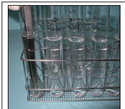
Fig. 3 – Introdução do disco de papel de filtro na solução de H_2O_2 .
