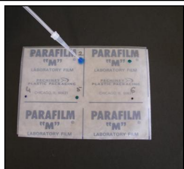
Fig. 8 – Mistura da amostra de DNA com o tampão de carregamento.
