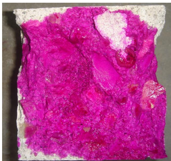
Figura 6.10. Provete sujeito a ensaio de carbonatação posteriormente a ser fraturado pelo ensaio de compressão
