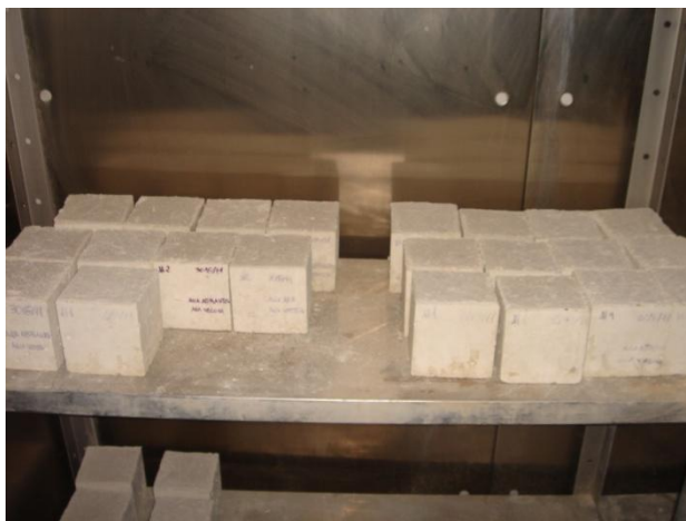
Figura 5.7. Armazenagem dos provetes em câmara húmida
