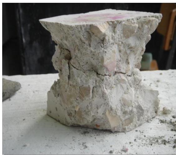
Figura 7.4. Modo de rotura evidenciado pelos provetes cúbicos após ensaio de compressão
