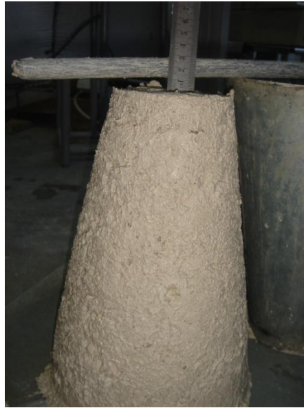
Figura 6.1. Ensaio de abaixamento realizado neste trabalho
