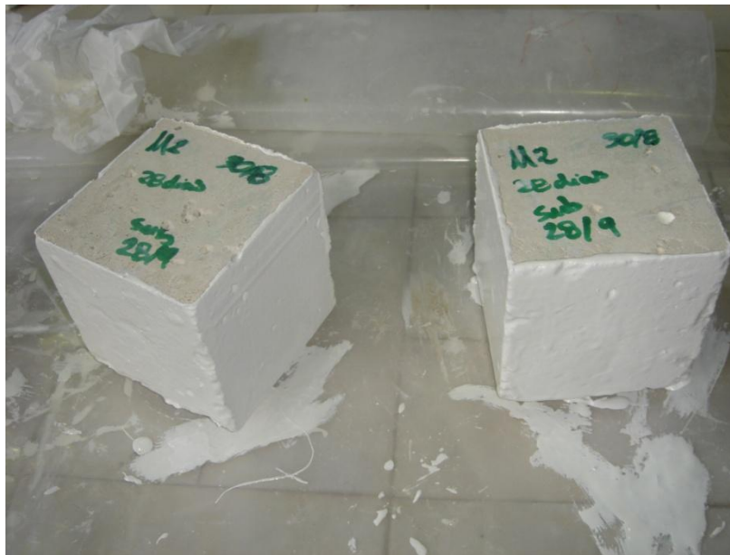
Figura 6.11. Isolamento dos provetes com Poxitar F, para posterior ensaio á penetração de cloretos
