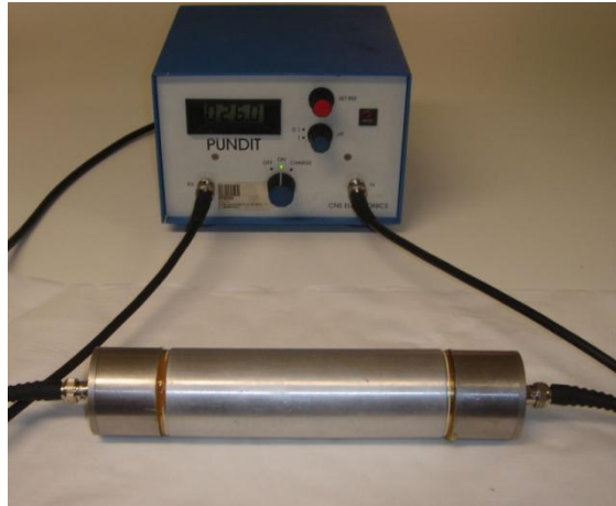
Figura 6.3. Aferição do aparelho utilizado na medição da velocidade de propagação dos ultra-sons (PUNDIT)
