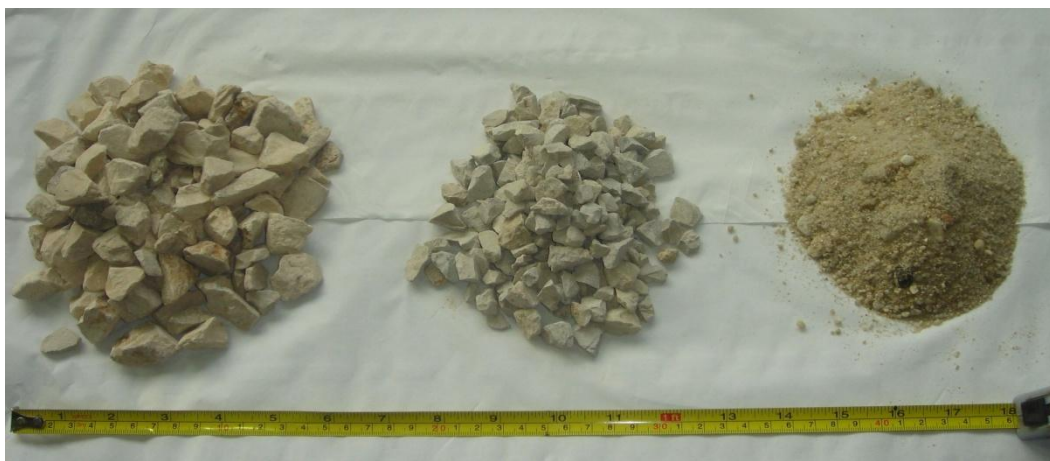
Figura 5.1. Agregados utilizados neste trabalho. Da esquerda para a direita: Brita grossa (brita 12/25), Brita fina (Brita 8/12) e areia.
