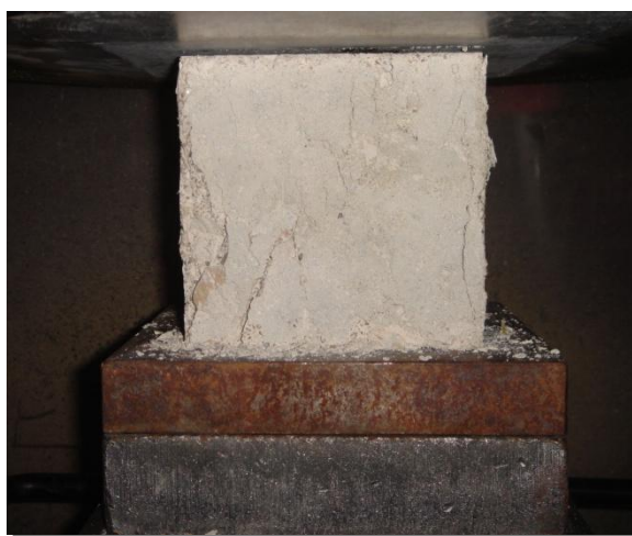
Figura 7.3. Modo de rotura evidenciado pelos provetes cúbicos durante o ensaio de compressão
