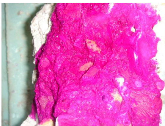
Figura 7.10. Provete de composição M0 aos 180 dias de idade sujeito ao ensaio de fenolftaleína após ensaio de compressão.
