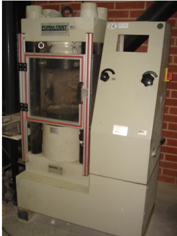
Figura 6.6. Prensa utilizada no ensaio de compressão dos provetes
