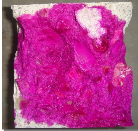
Figura 7.12. Provete de composição M2 aos 180 dias de idade sujeito ao ensaio de fenolftaleína após ensaio de compressão.
